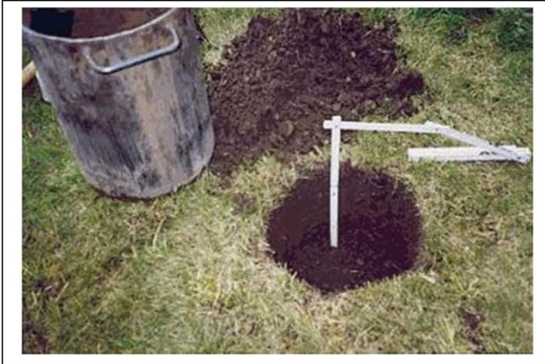
Fig. 13: Prova di Permeabilità superficiale
