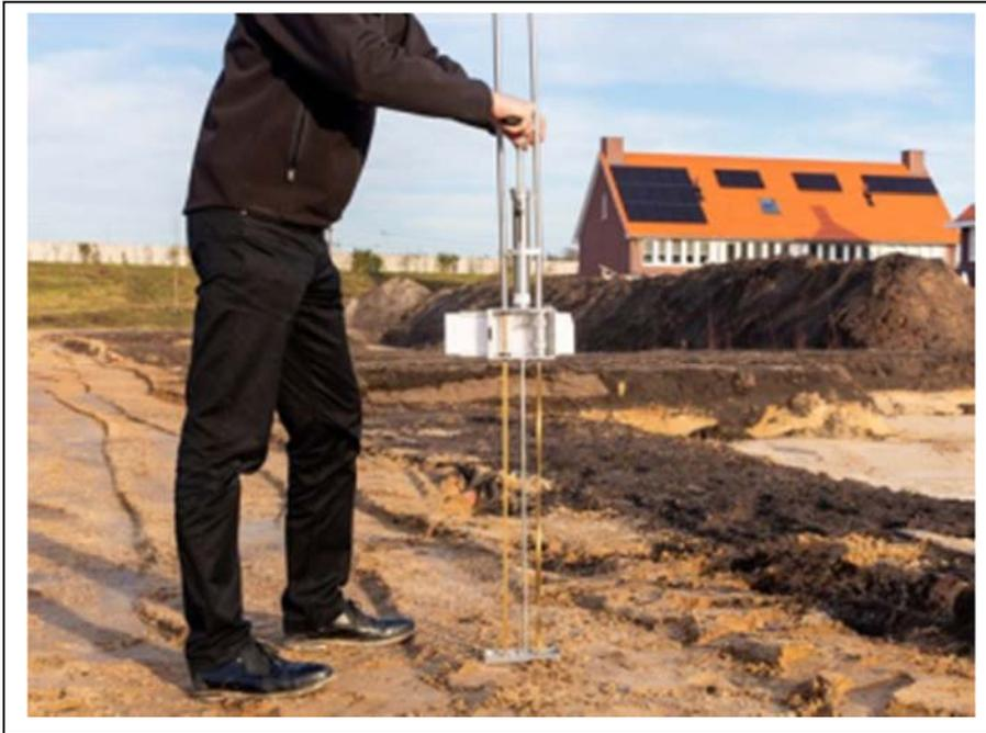
Fig. 11: Penetrografo manuale per misure di compattazione del terreno
