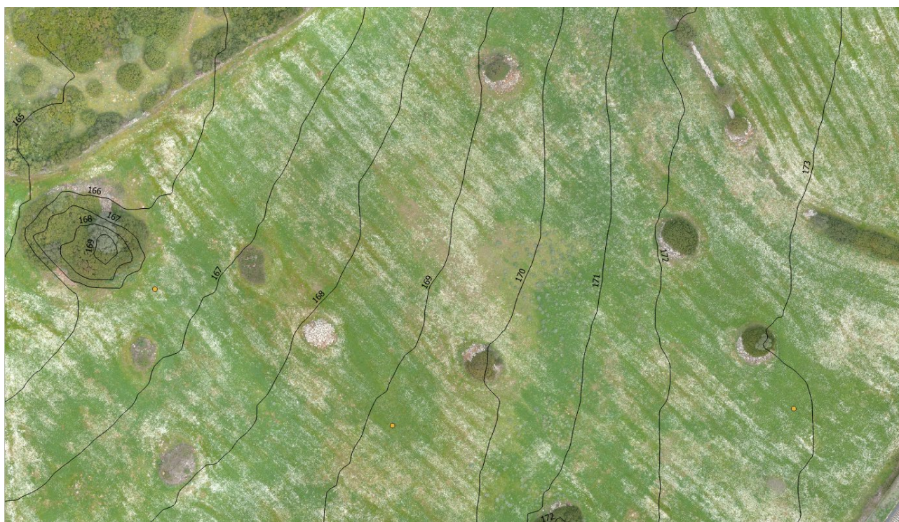
Figura 7 – Stralcio di output ottenuto grazie alla sovrapposizione in GIS delle curve di livello, dell'ortomosaico e dei GCP
