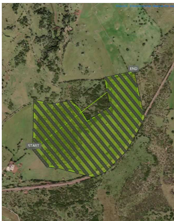
Figura 4 – Esempio di pianificazione di una missione di volo Pix4D capture (Bauladu – Area 4)
