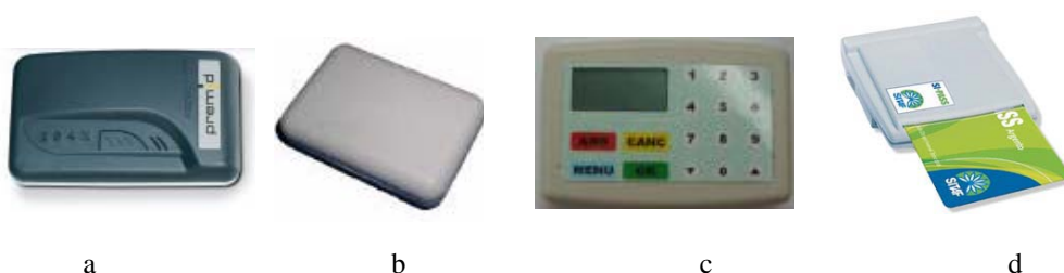
Figura 4:– Esempi di OBU DSRC realizzate secondo la Direttiva CE vigente:a), b): OBU ID only; c): OBU interattiva (PayCar); d): OBU integrata con Smart Card ISO 14443
