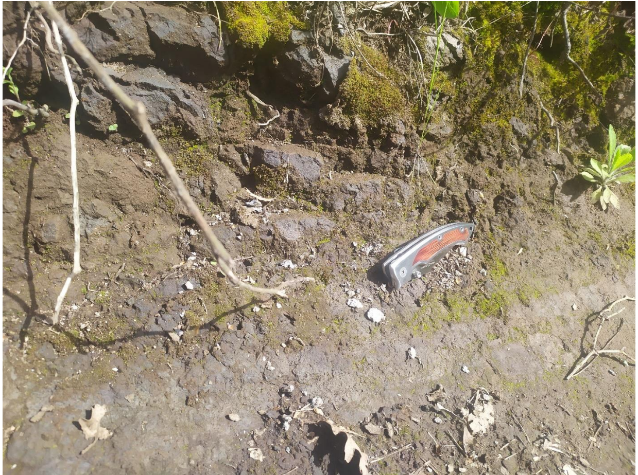
Figura 13: Profilo di alterazione dei Basalti della Subunità di Sindia. L'alterazione chimica è piuttosto profonda e ha causato la perdita della consistenza litoide dell'orizzonte superficiale in affioramento, che risulta sostanzialmente friabile.
