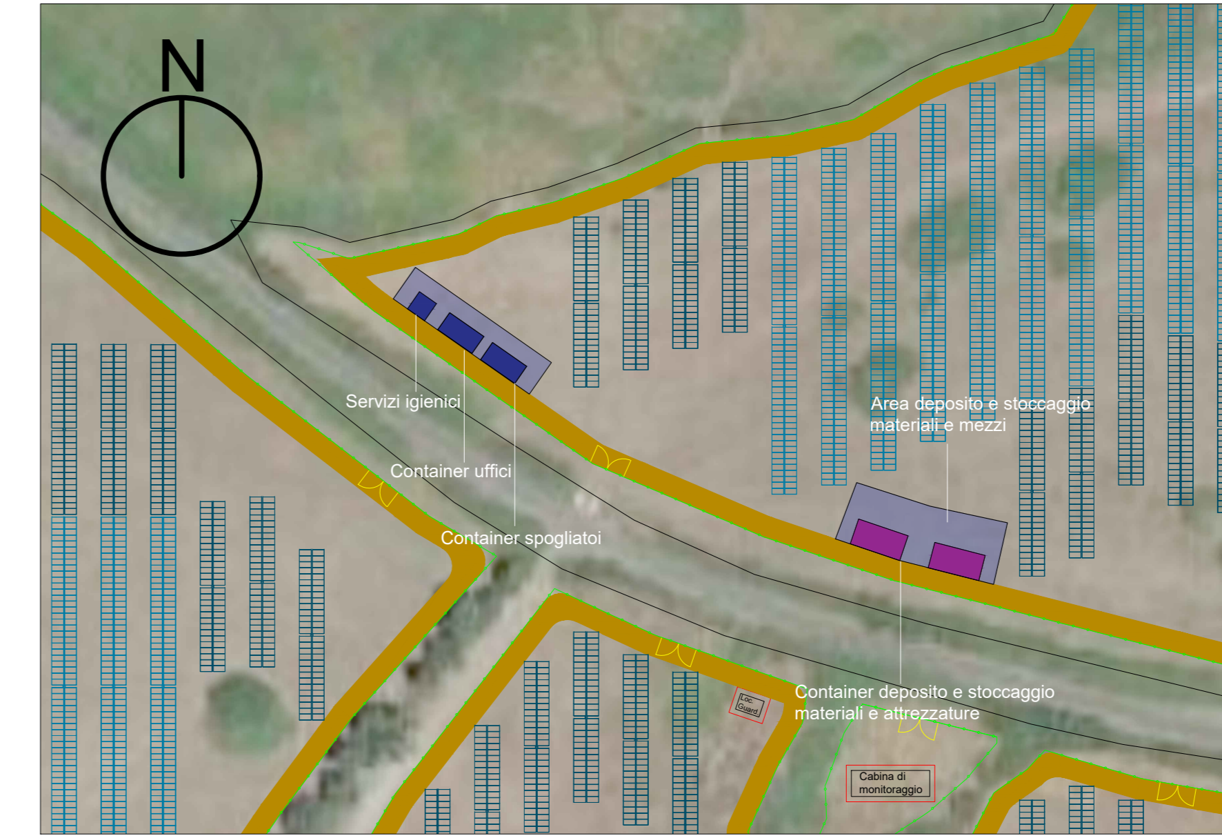
Particolare 5 aree cantiere - Scala 1:1000
