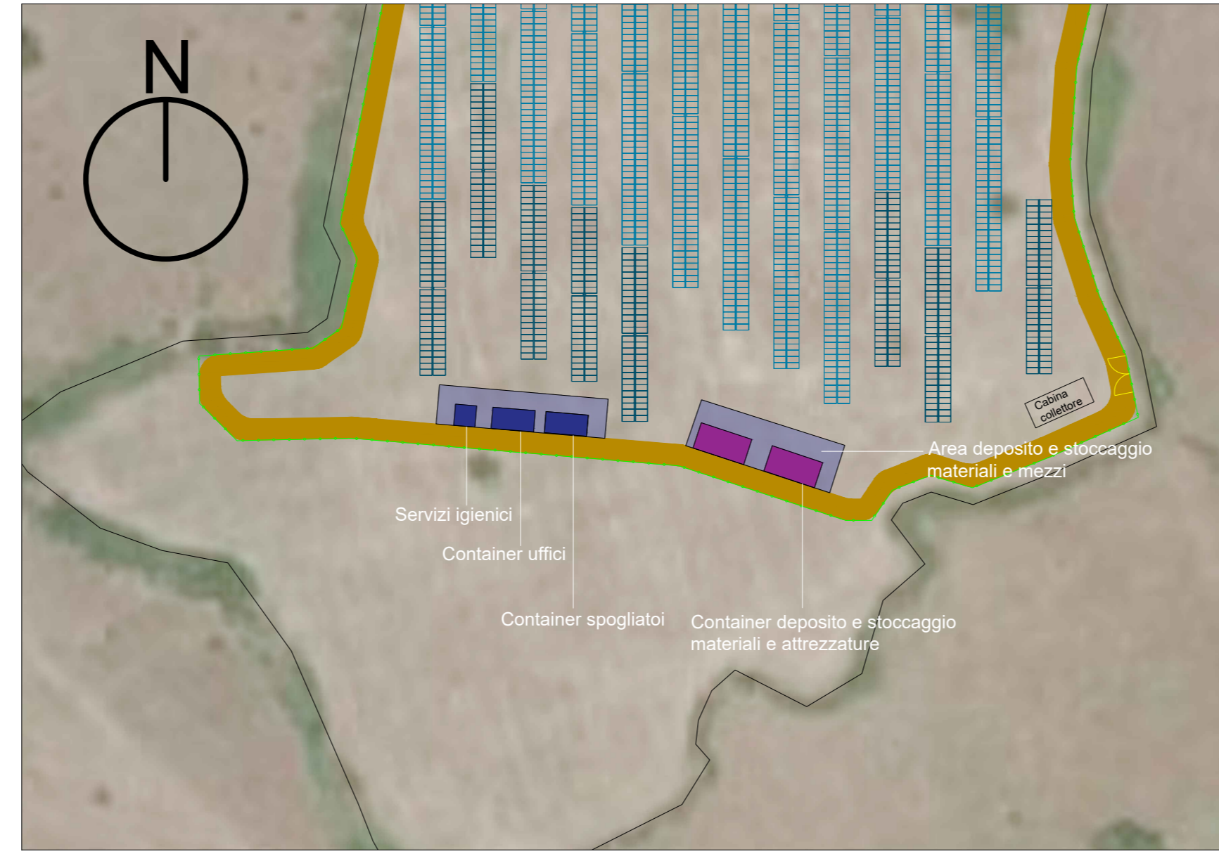
Particolare 4 aree cantiere - Scala 1:1000
