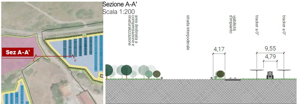
FIGURA 50 – PARTICOLARE AREA DESTINATA A CONSERVAZIONE E RELATIVA SEZIONE O-E DELL'IMPIANTO (ESTRATTO DALL'ELABORATO GRAFICO SINDIA2-PDT11)
