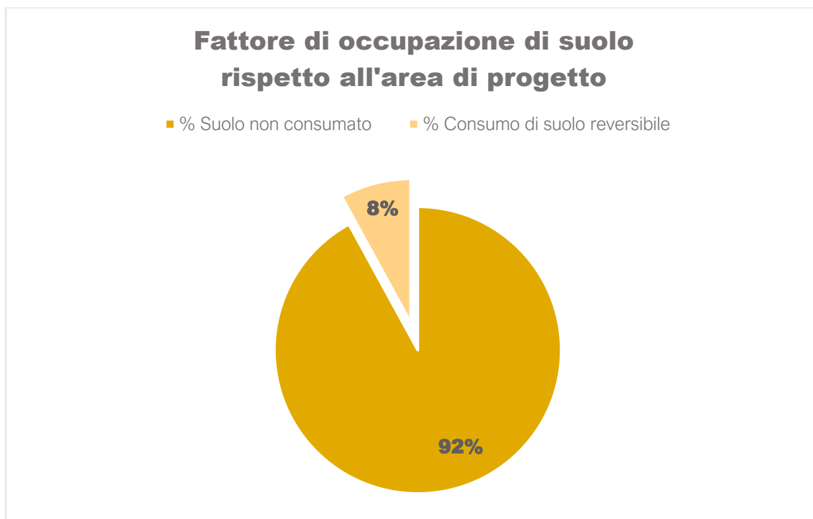
FIGURA 15 – INFOGRAFICA DEL FATTORE DI OCCUPAZIONE DEL SUOLO IN RELAZIONE AL PROGETTO AGRO-VOLTAICO OGGETTO DI STUDIO
