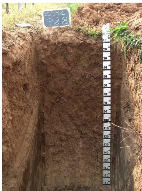
FIGURA 6 – ESEMPIO DI TRINCEA – FONTE: (ISPRA, 2010)
