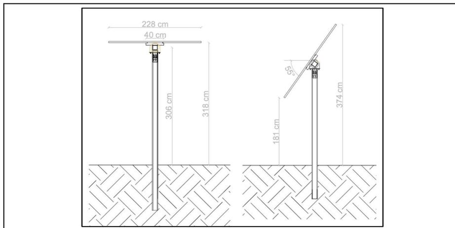
**Figura 3.1-2 - Schema Semplificativo Struttura Tracker**
