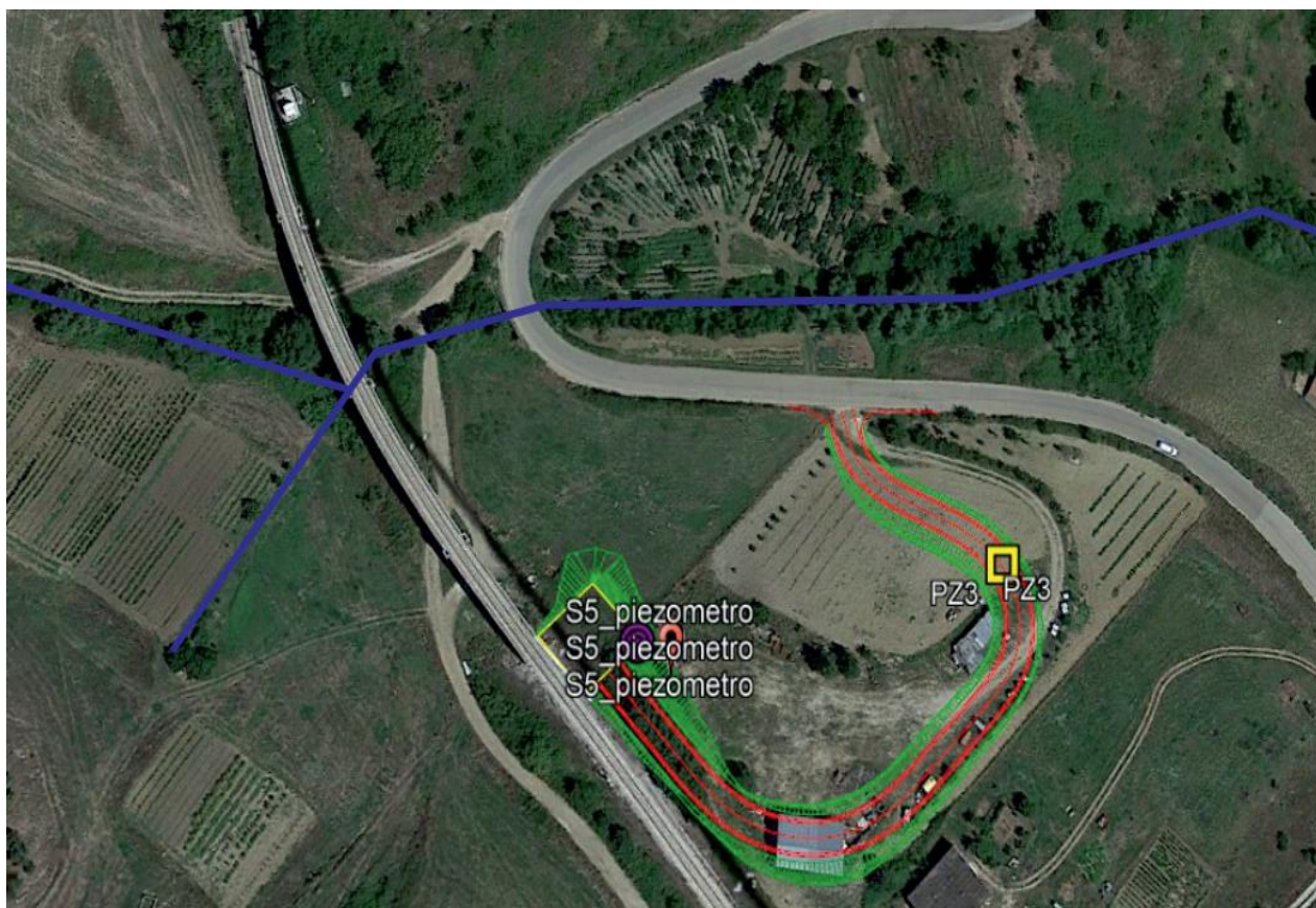
Figure 9-24 – Immagine dell'area di viabilità NV21 (Pietragalla) su cui è stato svolto il rilevamento geologico-geomorfologico
