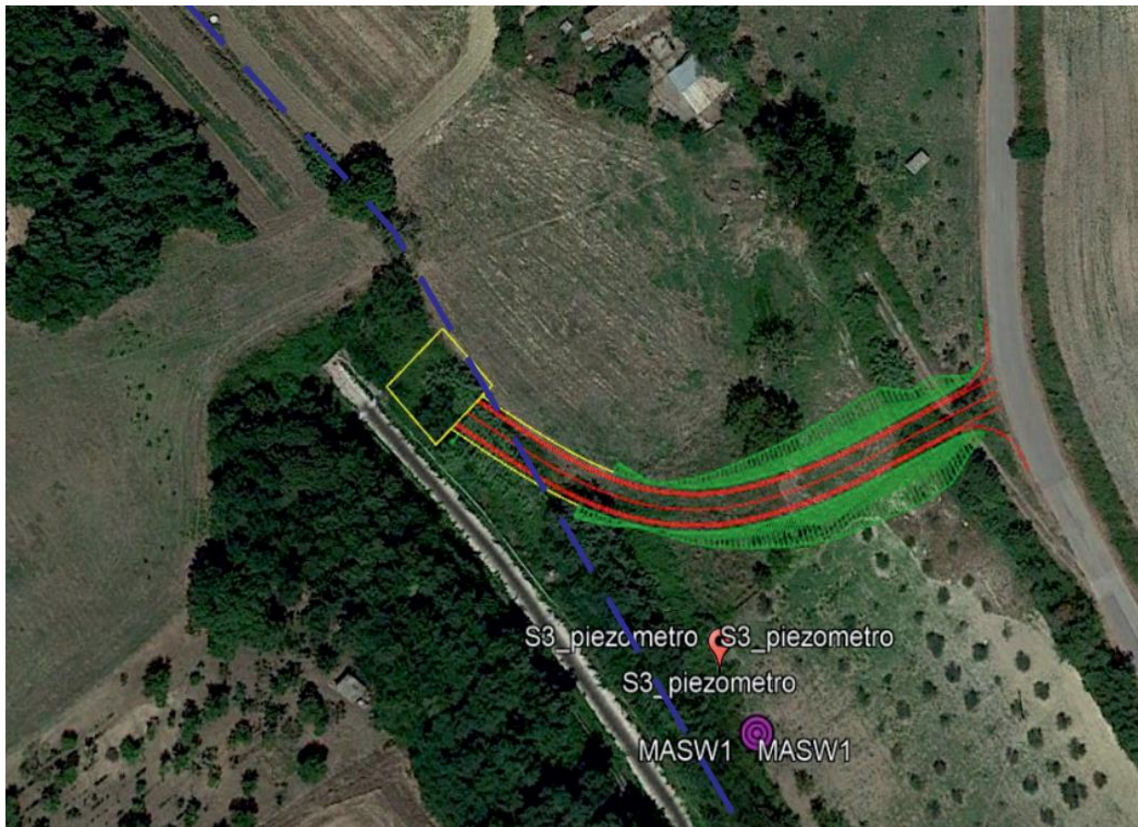
Figure 9-13 – Immagine dell'area di viabilità NV20 (Melfi) su cui è stato svolto il rilevamento geologico-geomorfologico
