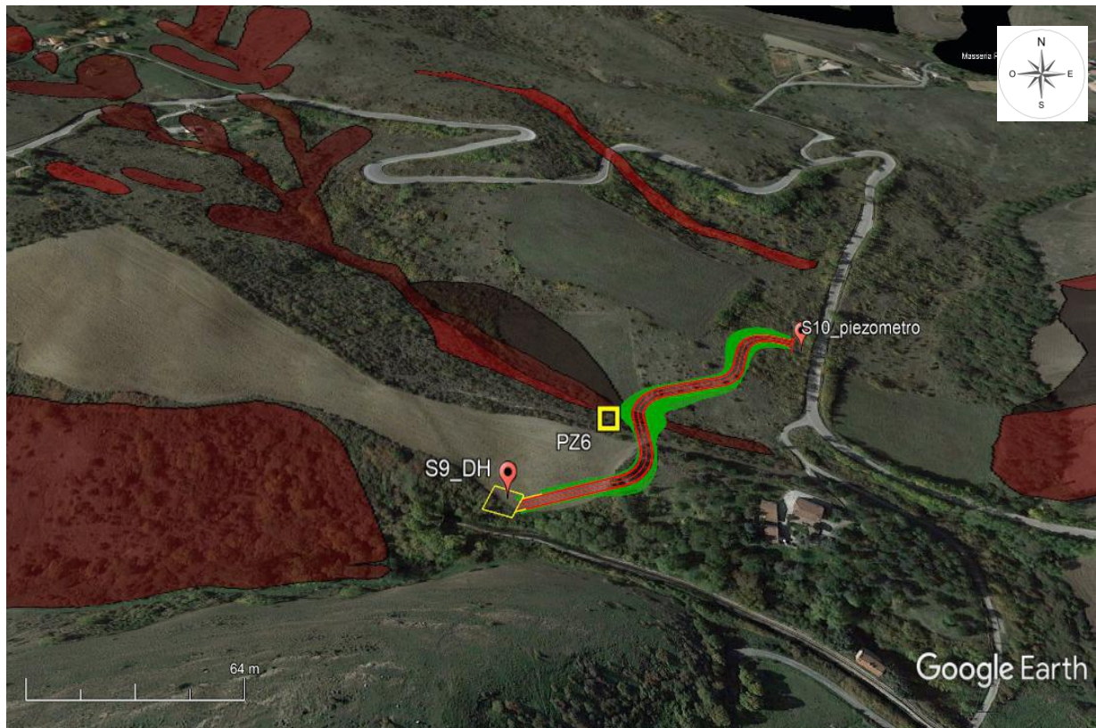
Figure 5-19 – Visualizzazione Google Earth dell'area di viabilità NV24 con sovrapposta la perimetrazione del PAI-dissesti e IFFI
