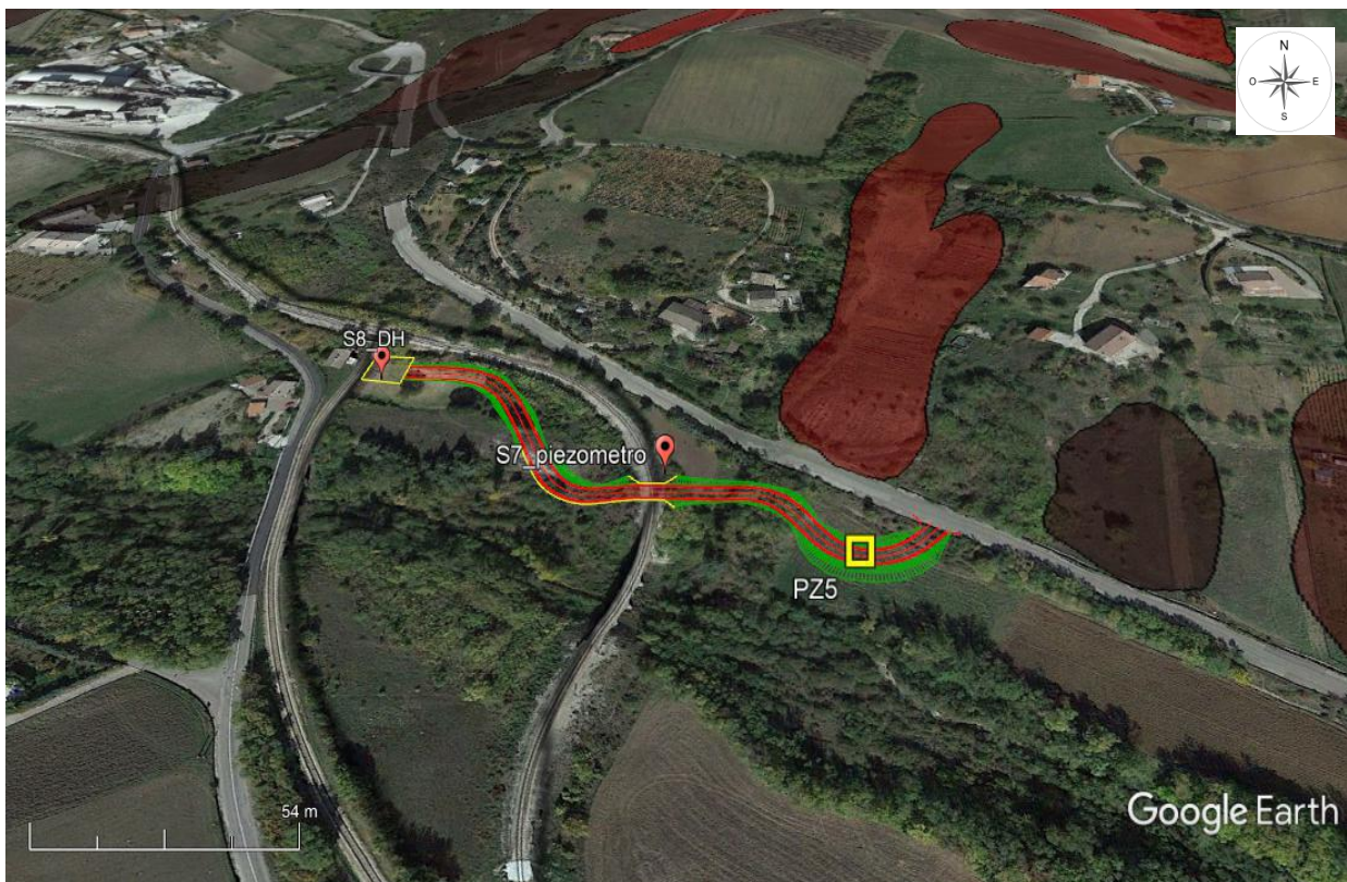
Figure 5-16 – Visualizzazione Google Earth dell'area di viabilità NV23 con sovrapposta la perimetrazione del PAI-dissesti e IFFI
