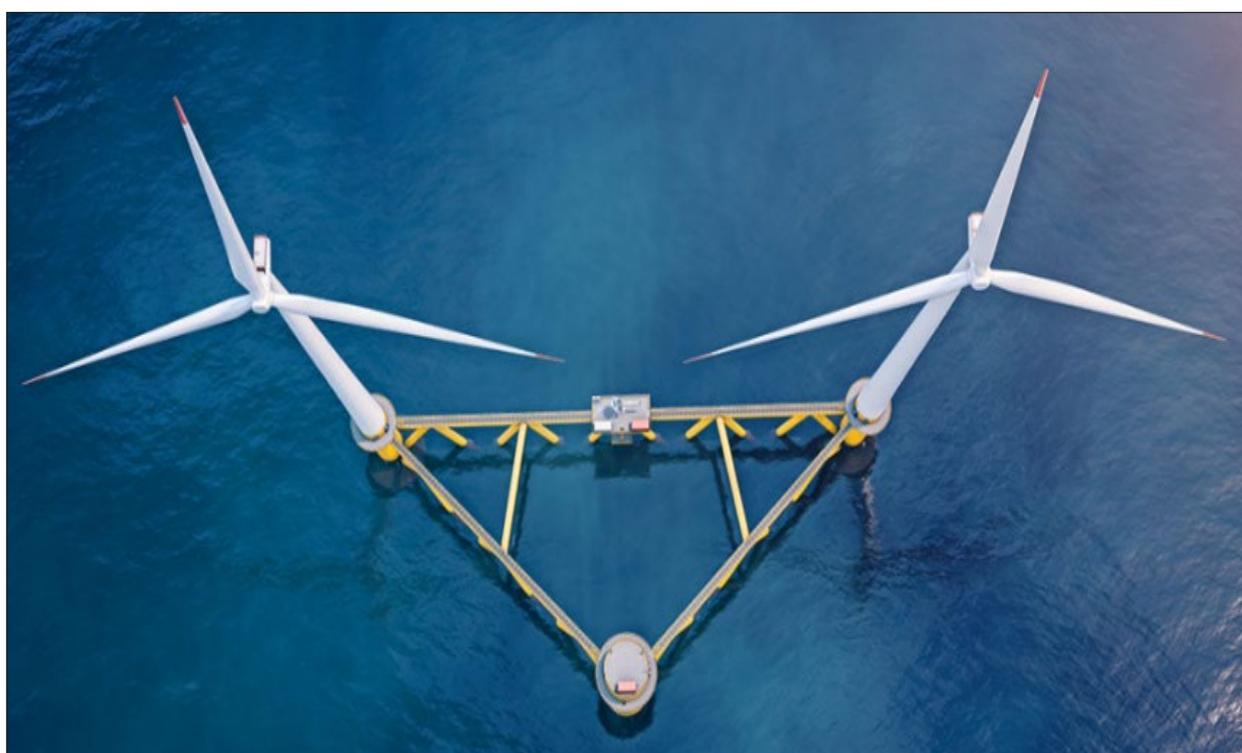
Figura 1.1: Turbina TwinWind™ di Hexicon
