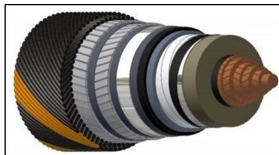
Figura 3: Struttura cavo HVAC a 380 kV
