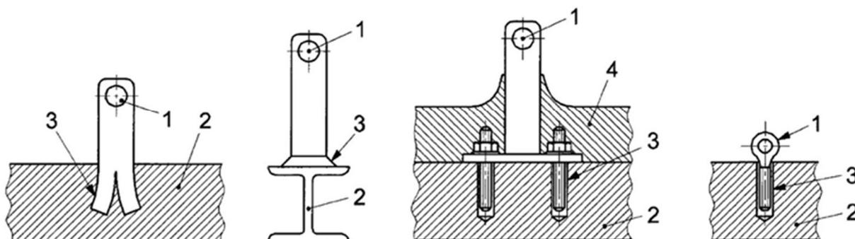
Quando il materiale base è a vista, come ad esempio travi di coronamento, parapetti e aggetti in cemento armato, coperture in lamiera, sarà indispensabile superare il pacchetto di copertura per individuare gli elementi strutturali in grado di assorbire i carichi determinati dall'arresto caduta.
