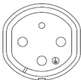
Il connettore **Tipo 3A** è provvisto di 4 contatti:
