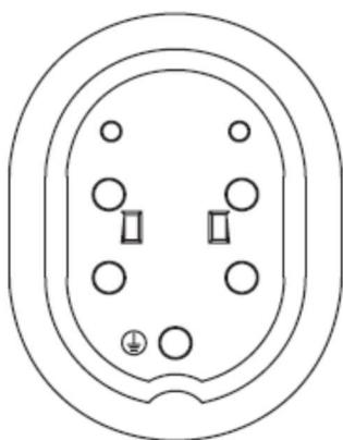
Il connettore **Tipo 3C** è provvisto di 7 contatti:
