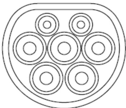
Il connettore **Tipo 2** è provvisto di 7 contatti:
