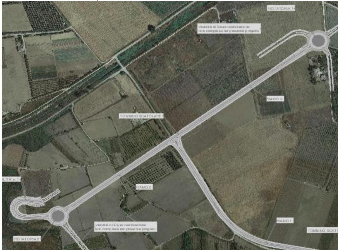
**Figura 13 – Planimetria di progetto del Ramo 2**
