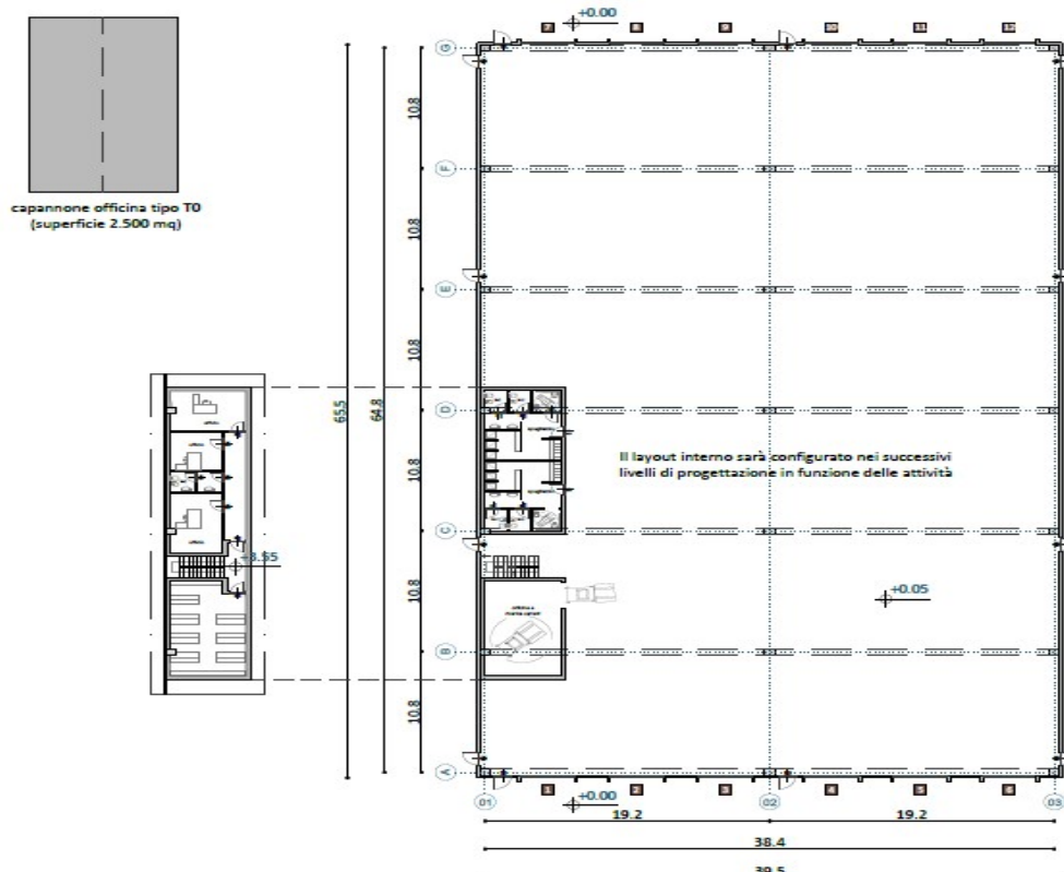
Pianta del capannone deposito mezzi e officina
