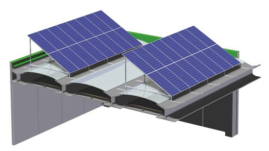
Sistema di copertura piana discontinua con travi in c.a.p. a "Y", tubolari in acciaio zincato e lastre curve in aluzinc. I tubolari in acciaio sono installati sulle travi in c.a.p. prima della realizzazione delle opere di impermeabilizzazione, permettendo l'appoggio di qualsiasi struttura per l'alloggiamento di pannelli fotovoltaici, opportunamente orientati.
