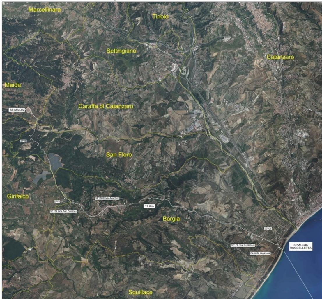
Figura 20: Percorso cavidotto terrestre su ortofoto.
