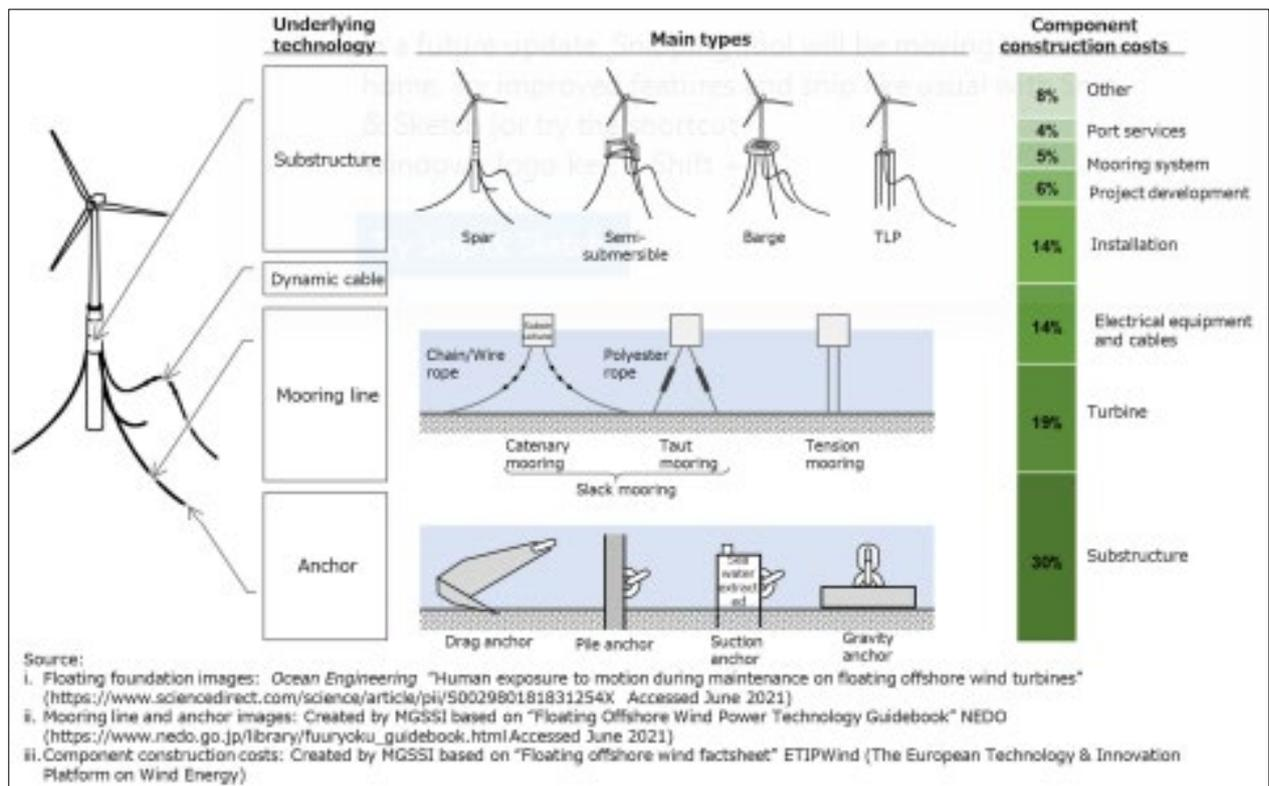
Figura 2.2: Tecnologie per l'energia eolica offshore galleggiante
