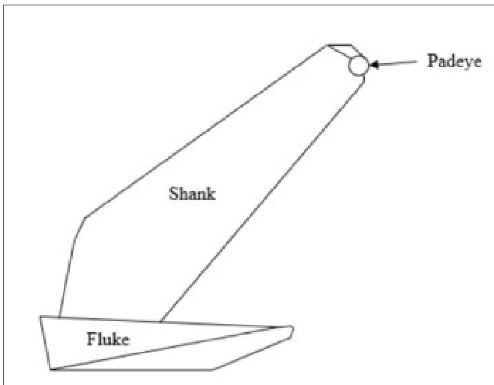
Figura 3.9: Componenti degli ancoraggi di trascinamento
