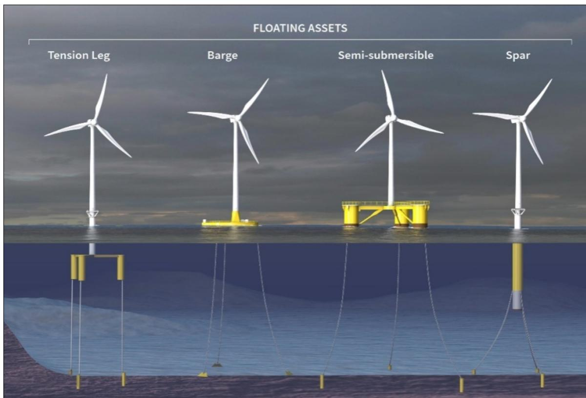
Figura 2.3: Tipi di fondazione degli aerogeneratori galleggianti ([www.acteon.com](http://www.acteon.com))
