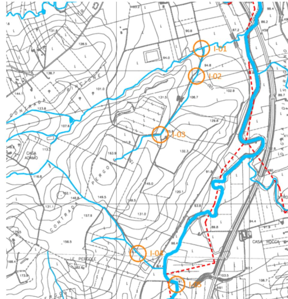
Figura 18. Stralcio della Tavola "Planimetria delle interferenze con rete idrografica" - interferenza passaggio del cavidotto MT (rosso)
