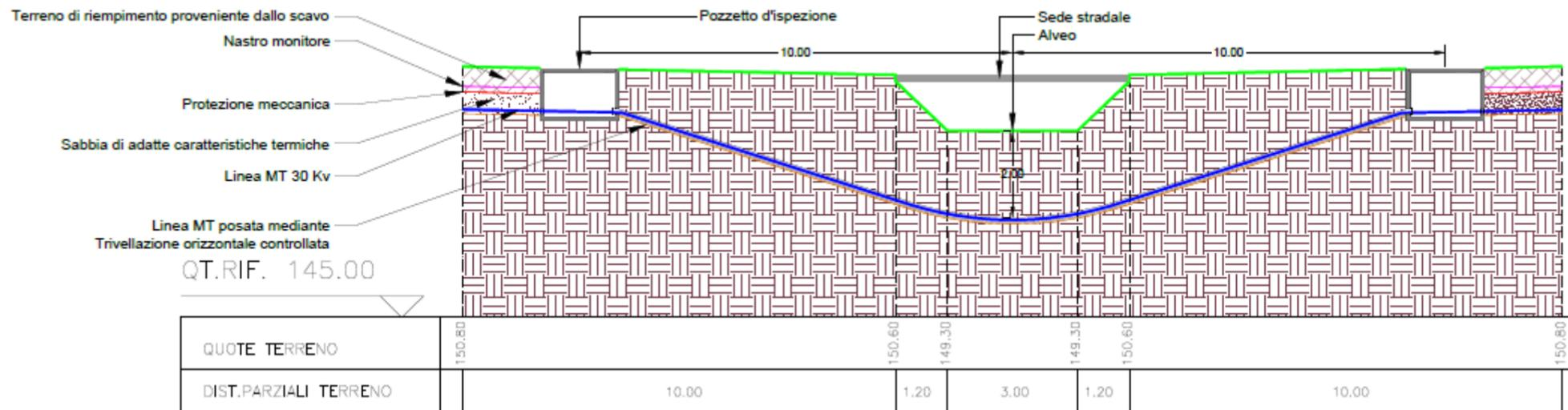
Figura 21. Schema di TOC- Trivellazione orizzontale controllata
