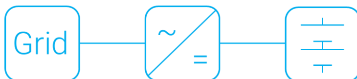
Figura 13 Schema semplificato di un convertitore monostadio
