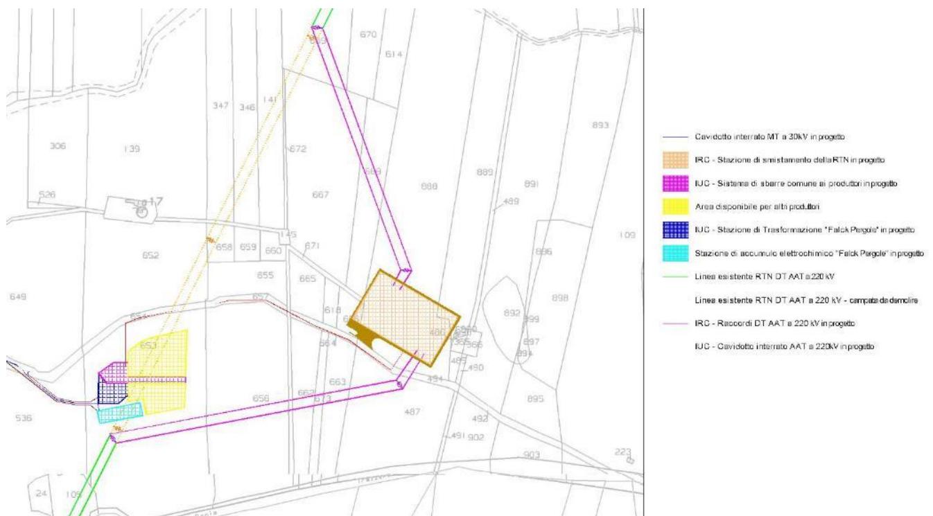
Figura 7 stazioni elettriche per il collegamento alla Rete di Trasmissione Nazionale (RTN) su base catastale (elaborazione interna)
