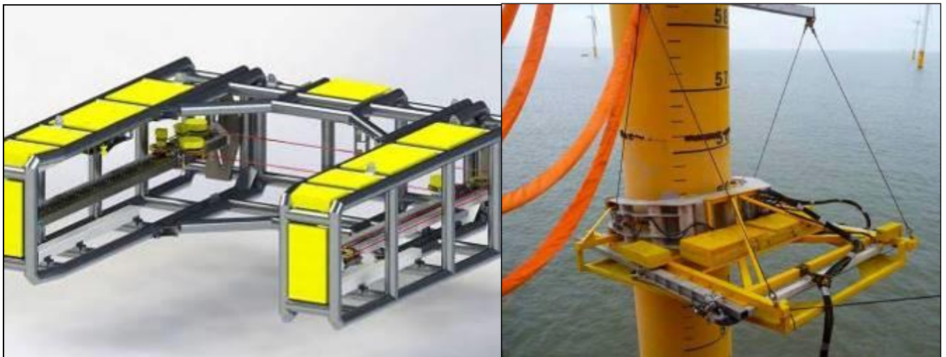
Figura 4.3 - Sistema per Taglio Esterno (Diamond Wire)
