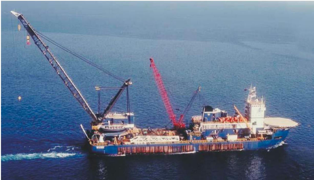
Figura 8.2 – Tipica Nave Gru con Gru a Braccio Mobile e Girevole
