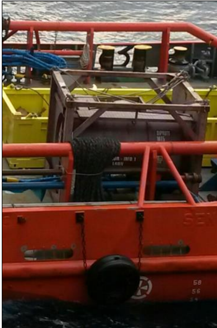
Figura 9.6 – Tipico Disposal Tank
