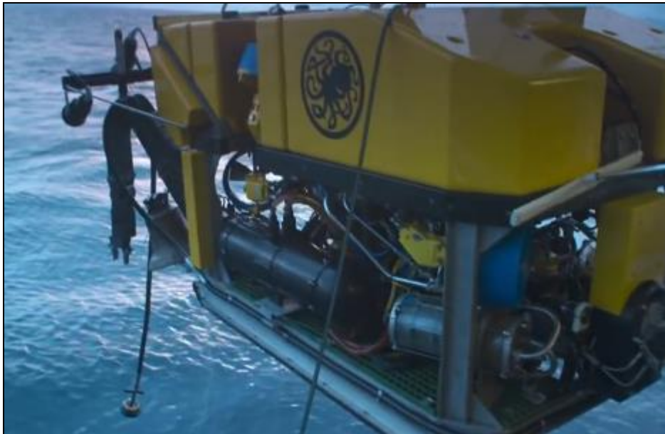
Figura 8.11 – Remotely Operated Vehicle Equipaggiato per Recupero
