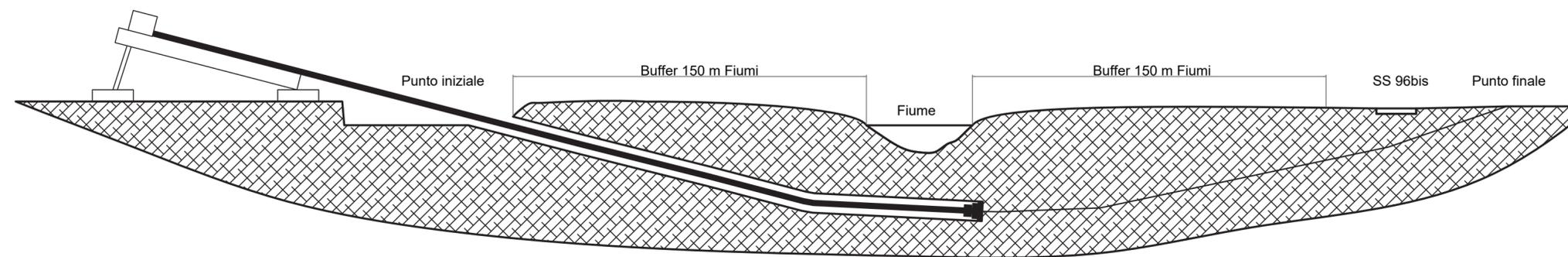
**Interferenza cavidotto / Corso d'acqua
