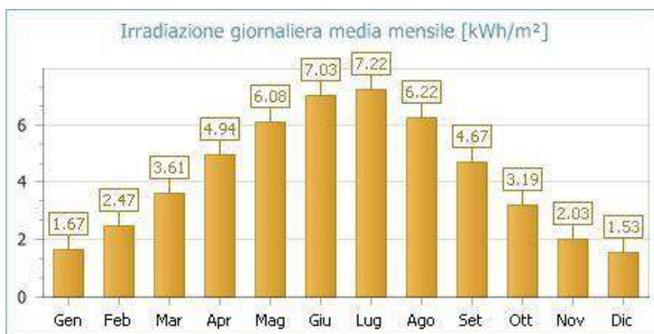
Figura 5.8. – Irradiazione giornaliera media mensile sul piano orizzontale [kwh/m²]- fonte dati: uni 10349 - località di riferimento: Potenza (PZ)/Matera (MT).
