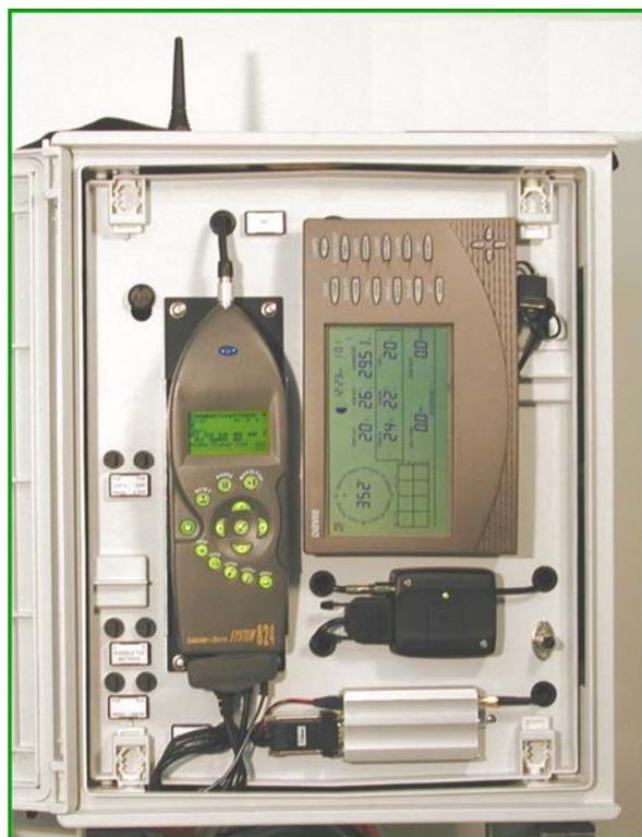
**LD 824 in box per il monitoraggio del rumore ambientale, completo di centralina meteo e trasmissione dati via GSM.**
