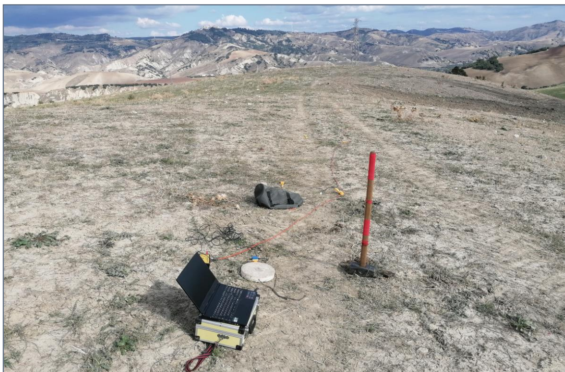
INDAGINI SISMICHE ESEGUITE NELL'AREA PARCO FOTOVOLTAICO
