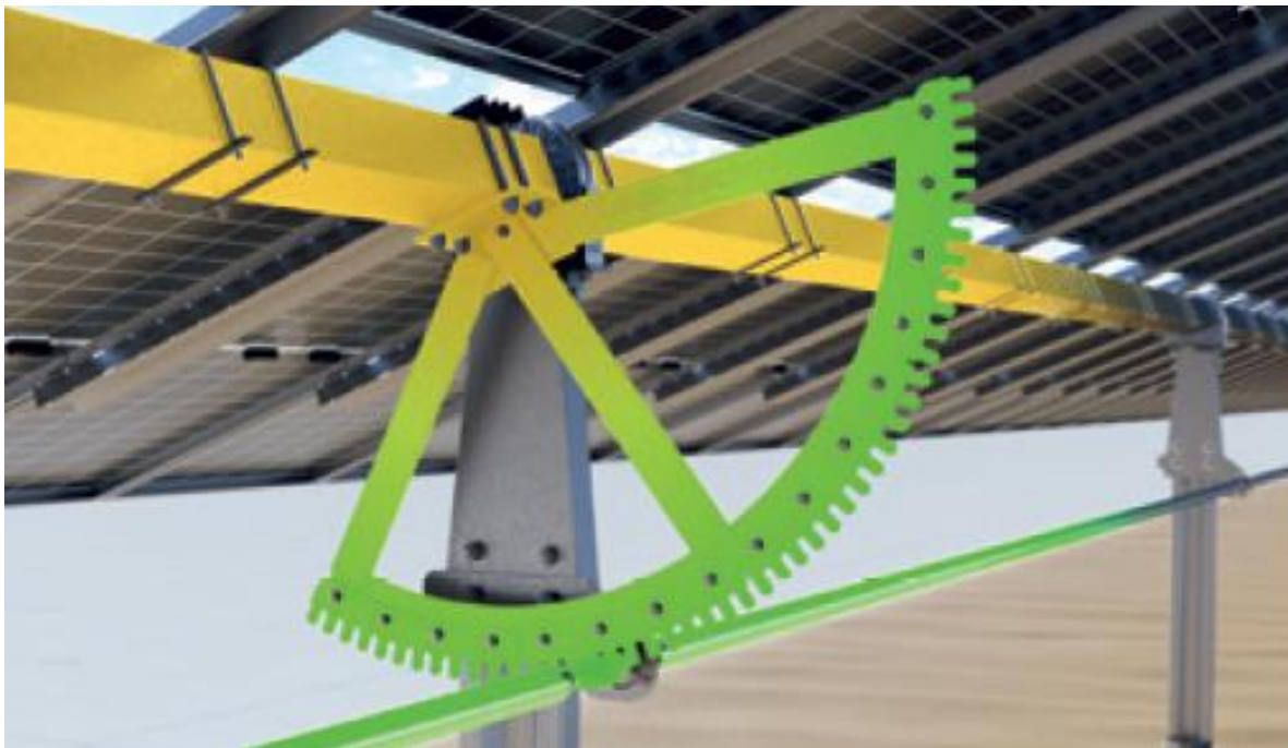
Dettaglio movimentazione con inseguitore monoassiale Est-Ovest
