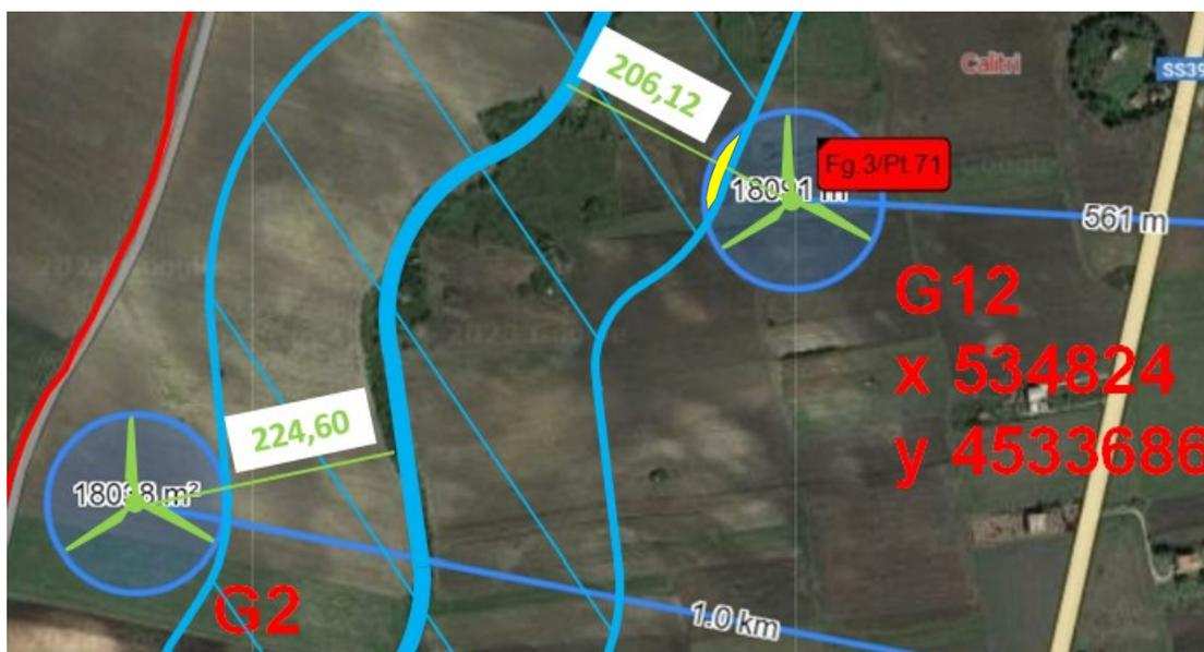
**Fig. 5 - Interessamento della fascia di rispetto fluviale di 150 ml con la proiezione a terra del rotore del WTG 12**
