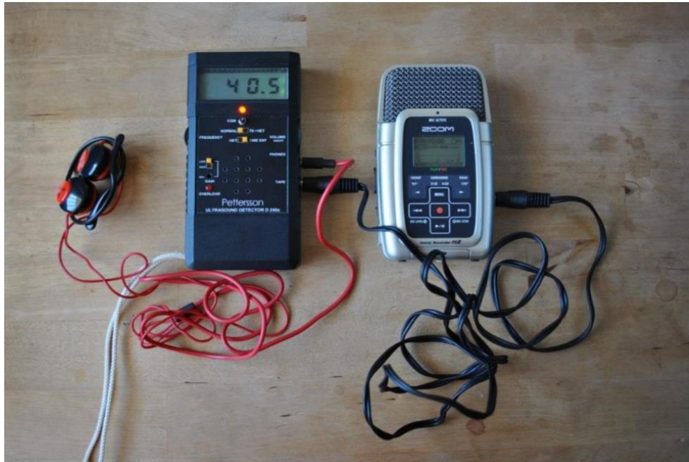
Figura 4-2: Strumentazione per i rilievi ultrasonori manuali: a sinistra bat detector D240 X Pettersson Elektronik, a destra Registratore Digitale Zoom H2; Foto di Federica Roscioni
