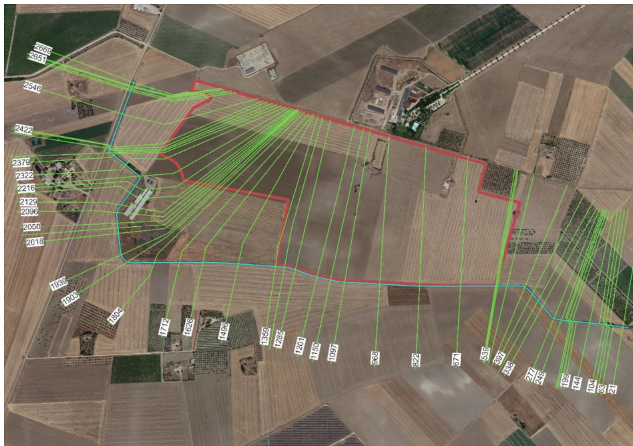
Figura 6.2: Sezioni trasversali dell'alveo e dei ponti modellate in Hec Ras, in rosso il perimetro dell'impianto fotovoltaico
