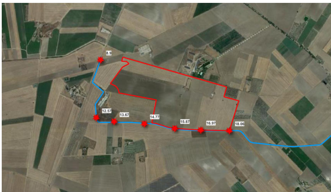
Figura 5.7: Schema idrologico – idraulico adottato per l’inserimento delle portate di progetto nella modellazione idraulica
