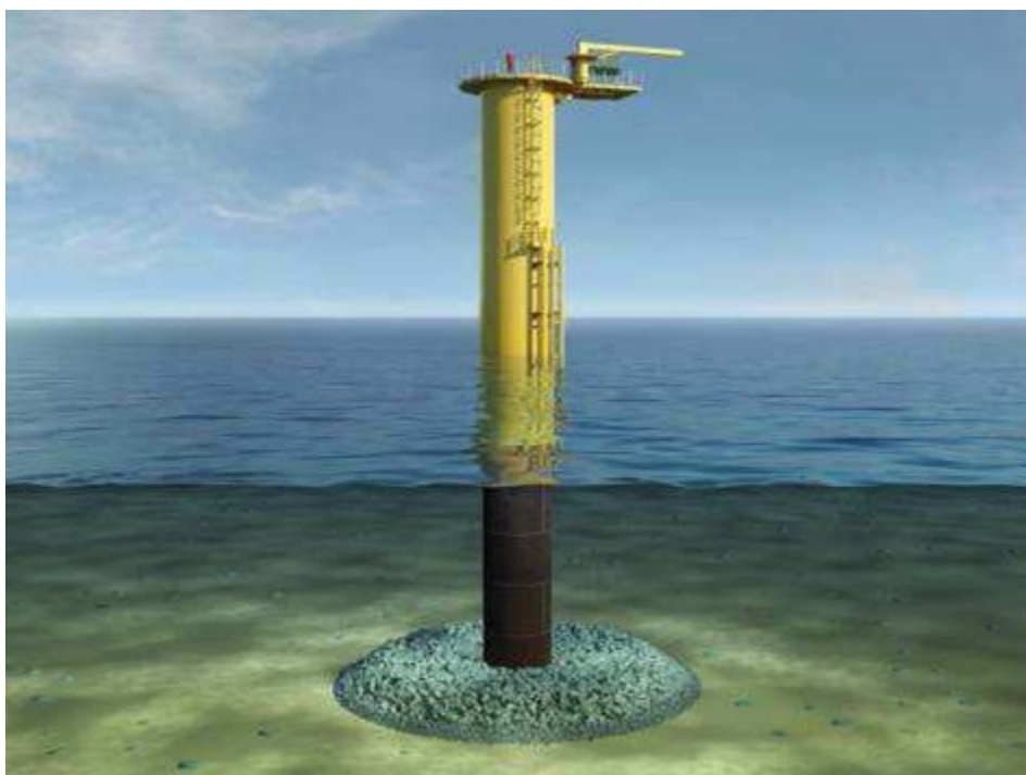
Esempio di fondazione monopalo per aerogeneratore offshore.
