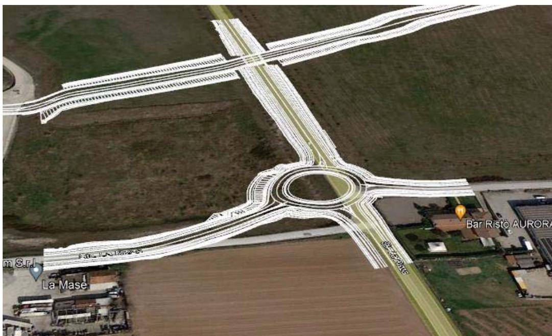
**Fig.16-Intersezione Strada La Rizza-via Ca Brusà con rotatoria di progetto**
