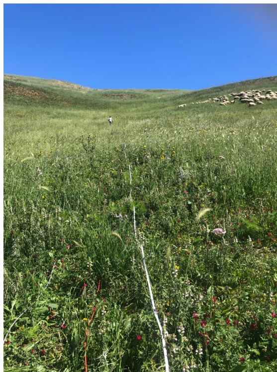
Foto Stendimento di sismica a rifrazione Rz6 e Mw6.
