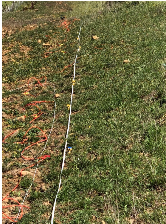
Foto Stendimento di sismica a rifrazione Rz5 e Mw5.
