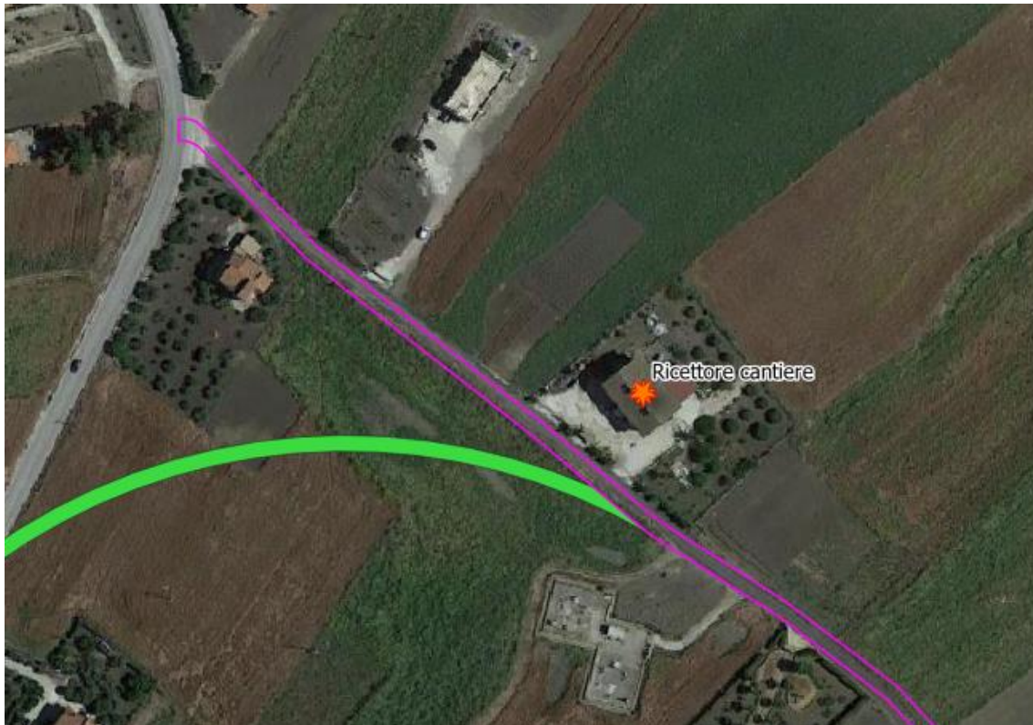
Figura 6-1 – Localizzazione del ricettore scelto per lo studio dell’impatto acustico del transito veicolare in fase di costruzione del parco eolico. In colore verde è indicata la strada di cantiere.
