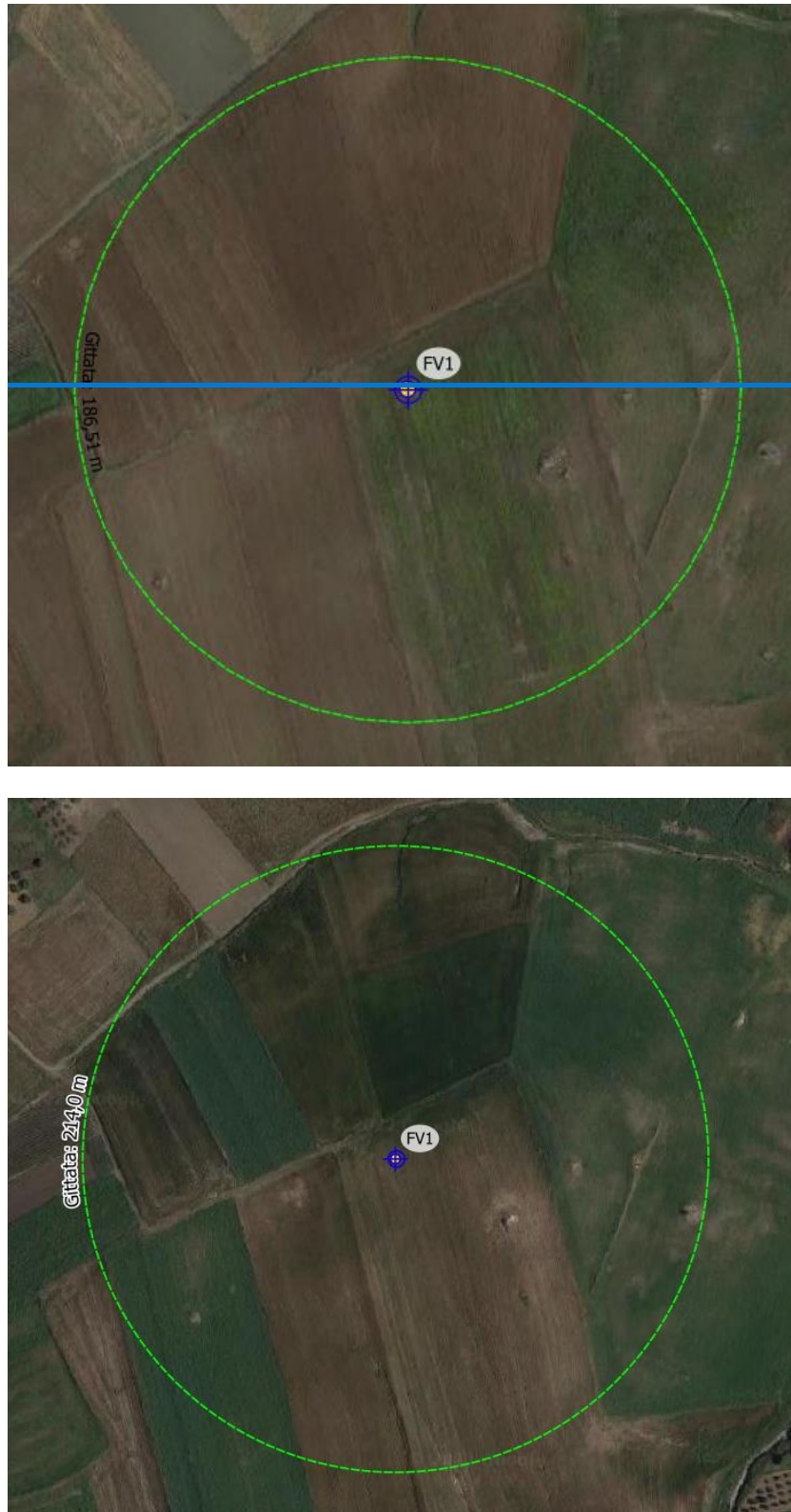
Figura 7-1 – Analisi degli effetti della rottura degli organi rotanti, aerogeneratore FV1
