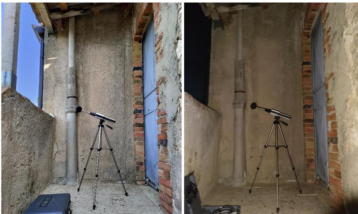
**Figura 4-33 – Esempio collocazione fonometro diurno/notturno**
