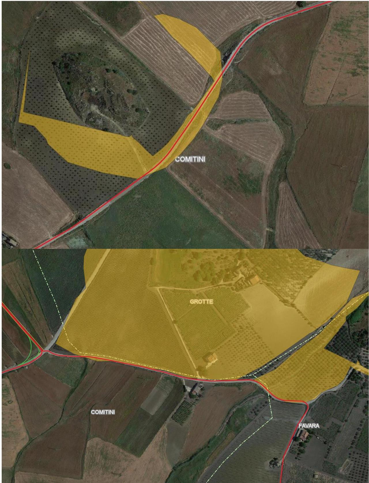
**Figura 2-11 – Aree di interesse archeologico ai sensi dell'art. 142 c.1 lett. m (in arancio), interferenze con cavidotto interrato sotto strada asfaltata**
