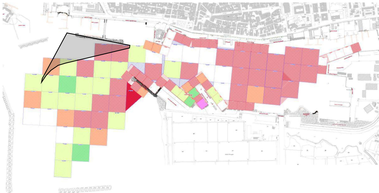
Figura 7 Distribuzione della classe di qualità dei sedimenti 0 – 0.5 m nel Porto di Trapani – estratto dalla relazione generale del progetto DRAGAGGIO AVAMPORTO E PONENTE SPORGENTE RONCIGLIO e sovrapposizione dell'area da dragare
