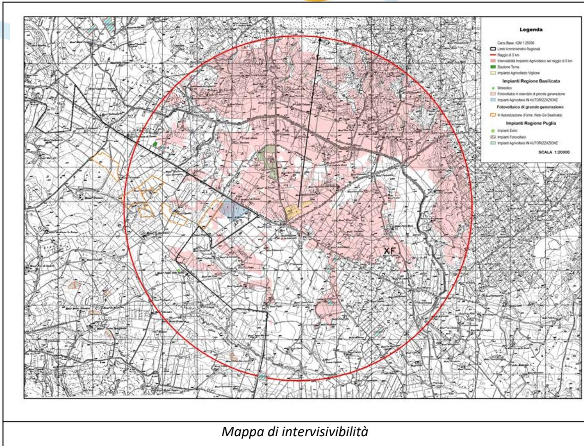
Per completare l'analisi dell'impatto cumulativo visivo, si è effettuata l'analisi di visibilità, condotta con la funzione denominata 'PROFILE TOOL' di QGis. Per l'implementazione della funzione è stato utilizzato il DTM 5m delle Regioni Puglia e Basilicata.
