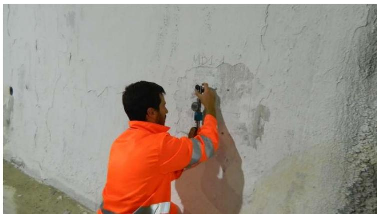
**Figura 4.9 - Lettura di zero sulle basi di misura**
