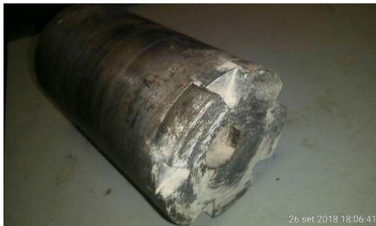
**Figura 5.3 - Fresa cieca per spianatura del fondo foro**
