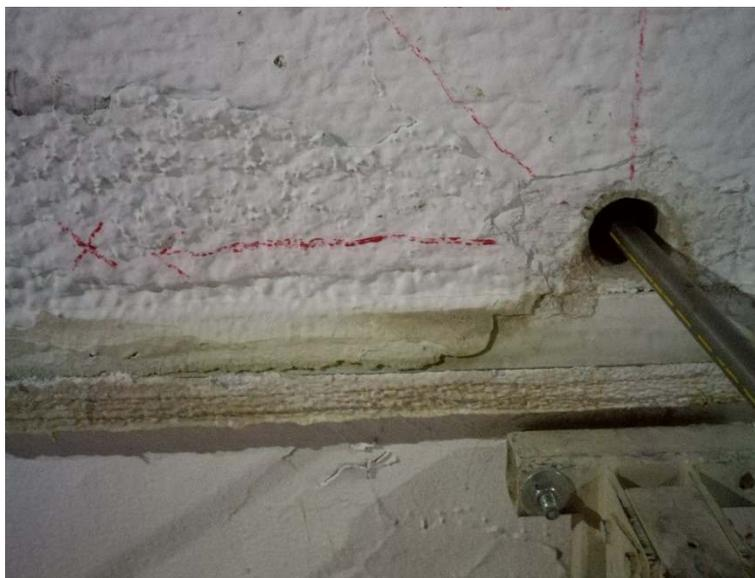
**Figura 5.7 - Incollaggio del doorstopper mediante asta di manovra orientata**
