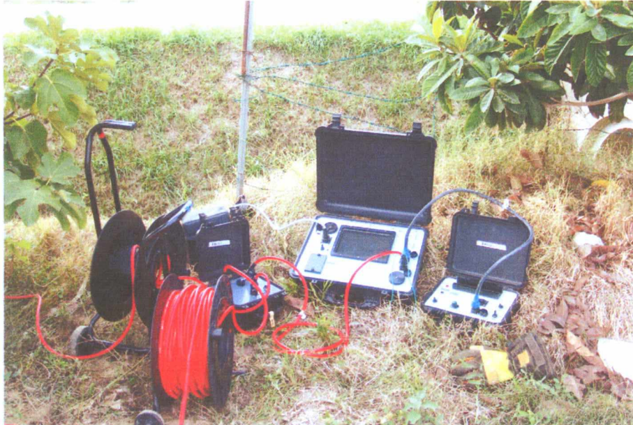
Foto 5 Apparecchiatura di acquisizione geoelettrica
