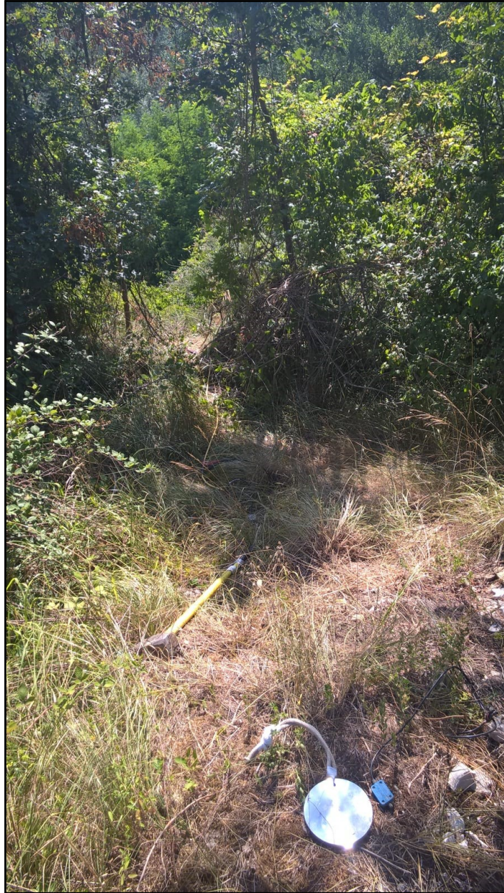
Figura 3: Dettaglio di una energizzazione con piastra di battuta e mazza per generare onde di compressione.
