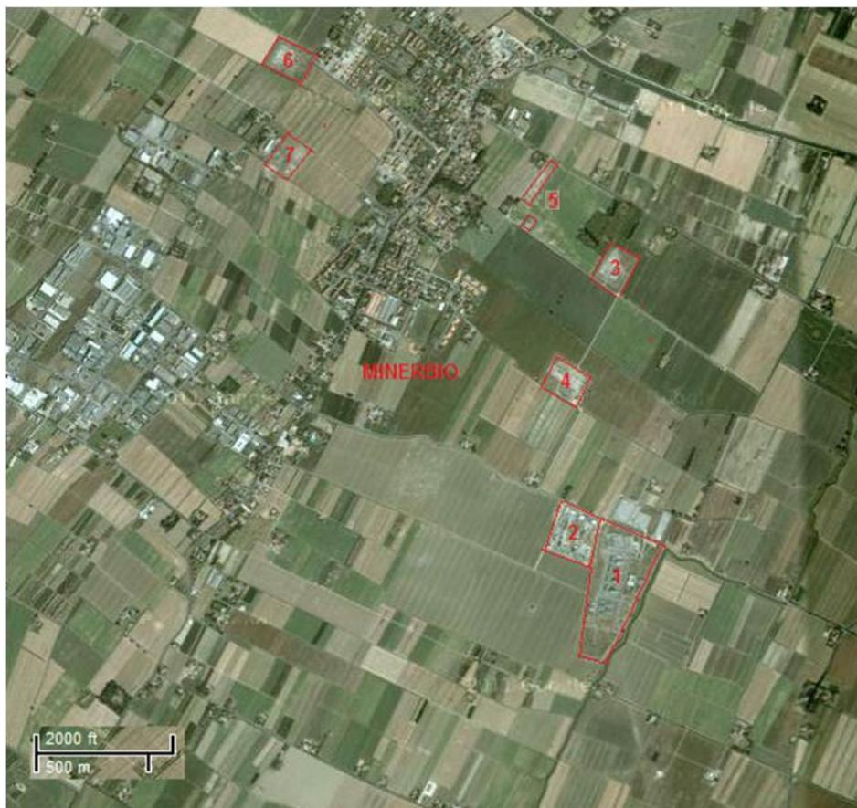
**Fig. 3.1.a – Principali infrastrutture della Concessione Minerbio Stoccaggio (base: immagine satellitare Google): (1) centrale compressione; (2) centrale trattamento; (3) cluster B; (4) cluster C; (5) cluster E-E1; (6) cluster A; (7) cluster D**
