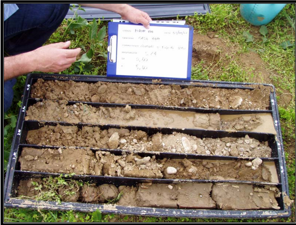
Sondaggio 24 – Cassetta catalogatrice n 1 (0,0 – 5,0 m da p.c.)
