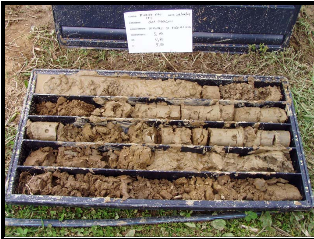
Sondaggio 15 – Cassetta catalogatrice n 1 (0,0- 5,0 m da p.c.)
