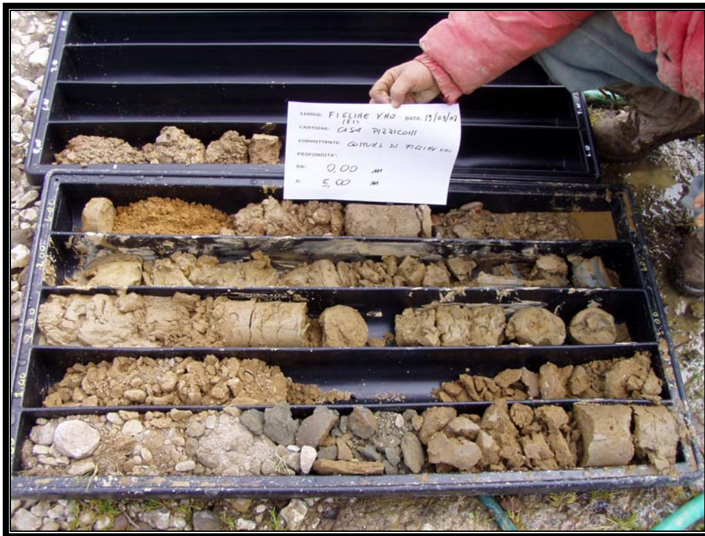
Sondaggio 14 – Cassetta catalogatrice n 1 (0,0 – 5,0 m da p.c.)
