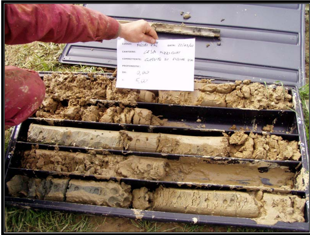
Sondaggio 11 – Cassetta catalogatrice n 1 (0,0 – 5,0 m da p.c.)
