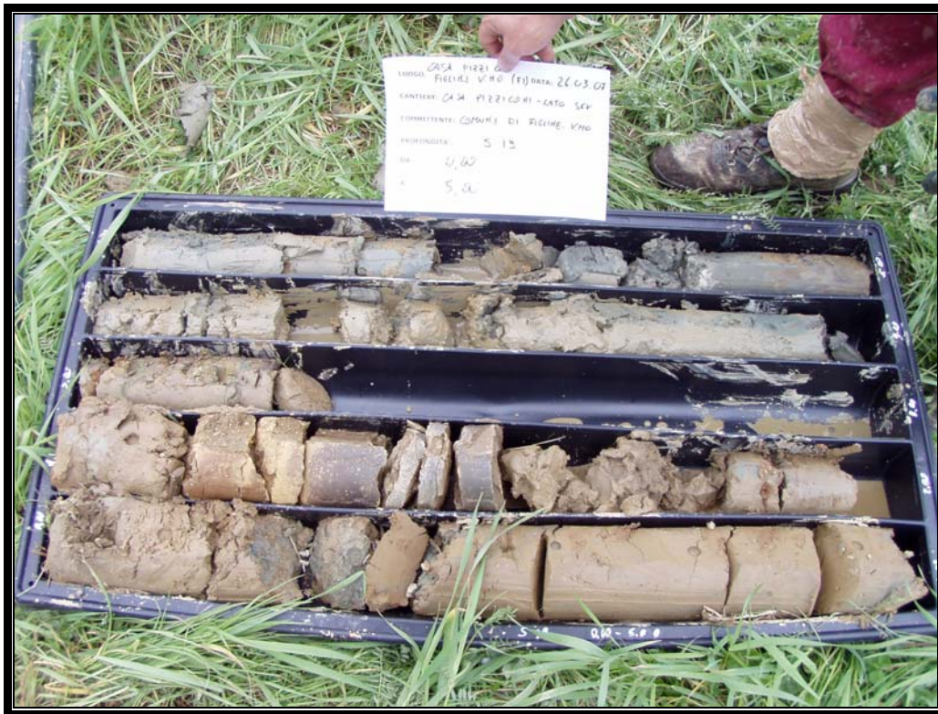
Sondaggio 19 – Cassetta catalogatrice n 1 (0,0 – 5,0 m da p.c.)
