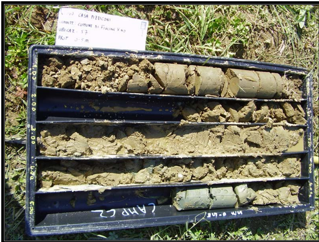
Sondaggio 7 – Cassetta catagolatrice n 1 (0,0- 5,0 m da p.c.)
