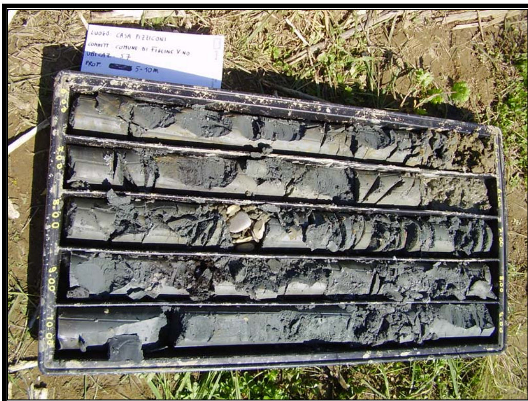
Sondaggio 7 – Cassetta catagolatrice n 2 (5,0 – 10,0 m da p.c.)
