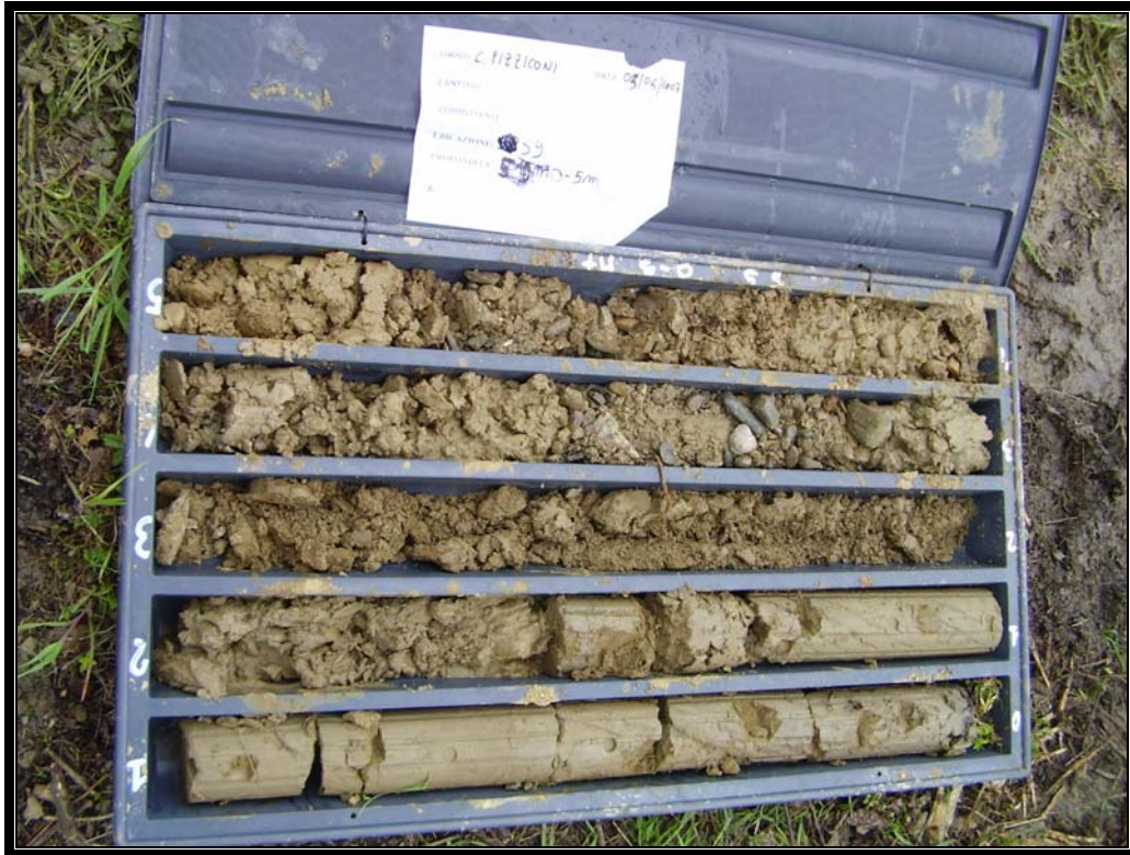
Sondaggio 9 – Cassetta catagolatrice n 1 (0,0 – 5,0 m da p.c.)
