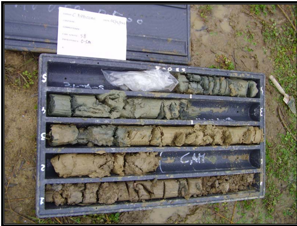
Sondaggio 8 – Cassetta catagolatrice n 1 (0,0 – 5,0 m da p.c.)
