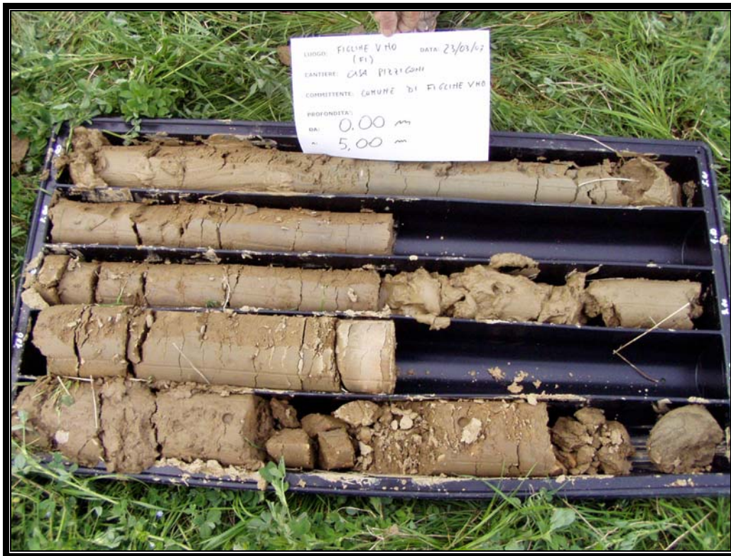
Sondaggio 16 – Cassetta catalogatrice n 1 (0,0 – 5,0 m da p.c.)
