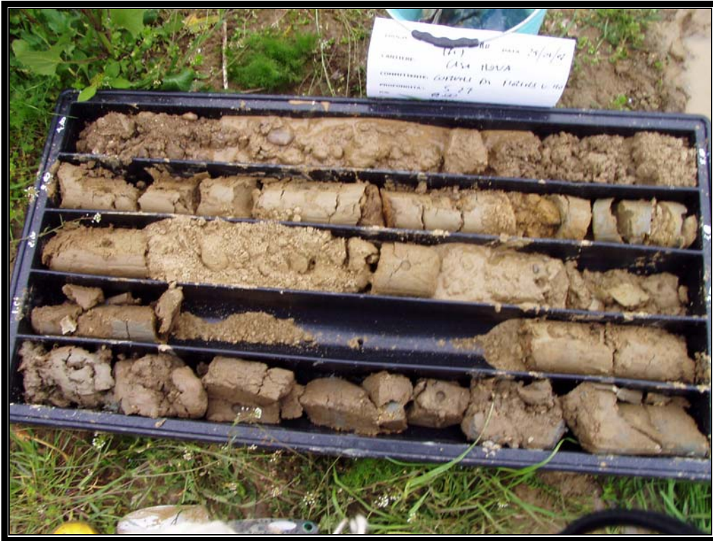
Sondaggio 27 – Cassetta catalogatrice n 1 (0,0 - 5,0 m da p.c.)
