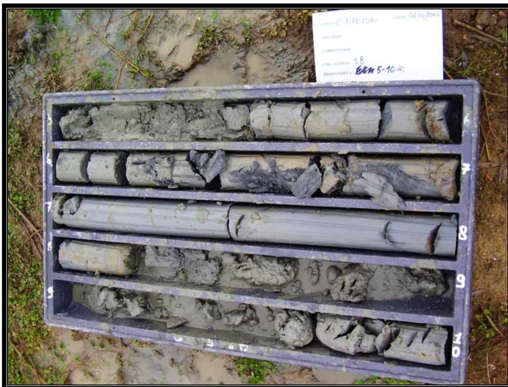
Sondaggio 8 – Cassetta catagolatrice n 2 (5,0 – 10,0 m da p.c.)
