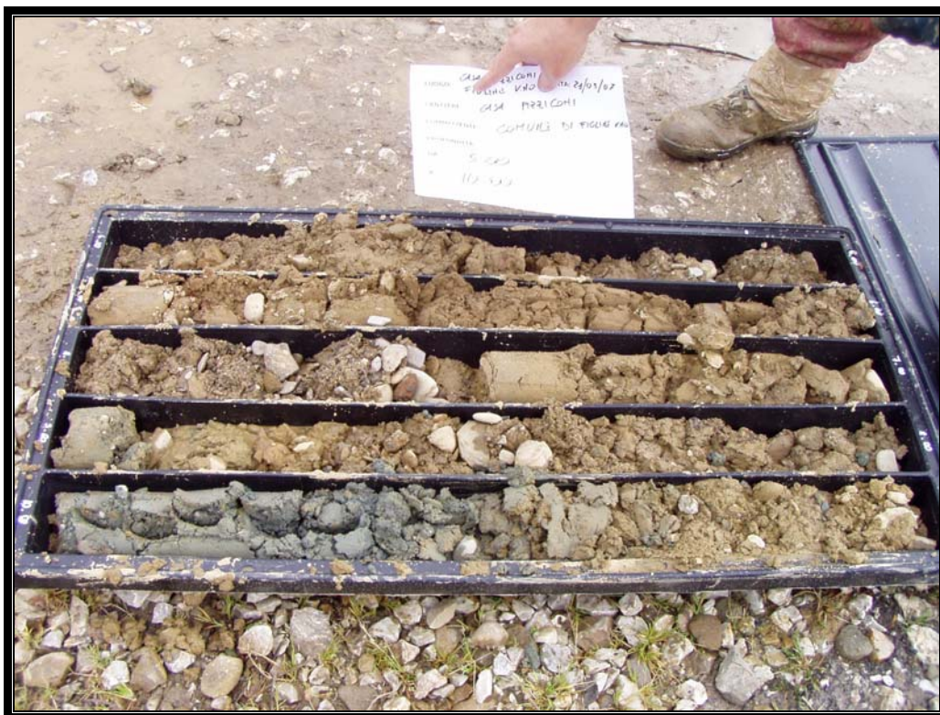
Sondaggio 14 – Cassetta catalogatrice n 2 (0,0 – 5,0 m da p.c.)
