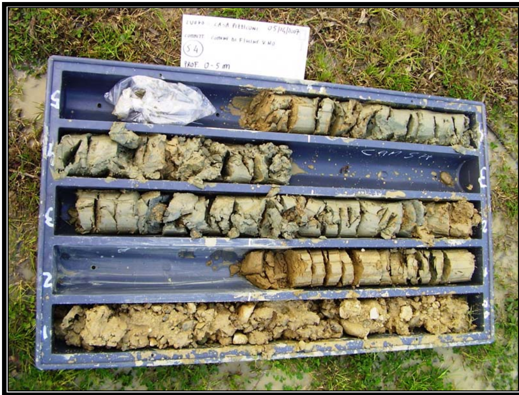
Sondaggio 4 – Cassetta catagolatrice n 1 (0,0 – 5,0 m da p.c.)
