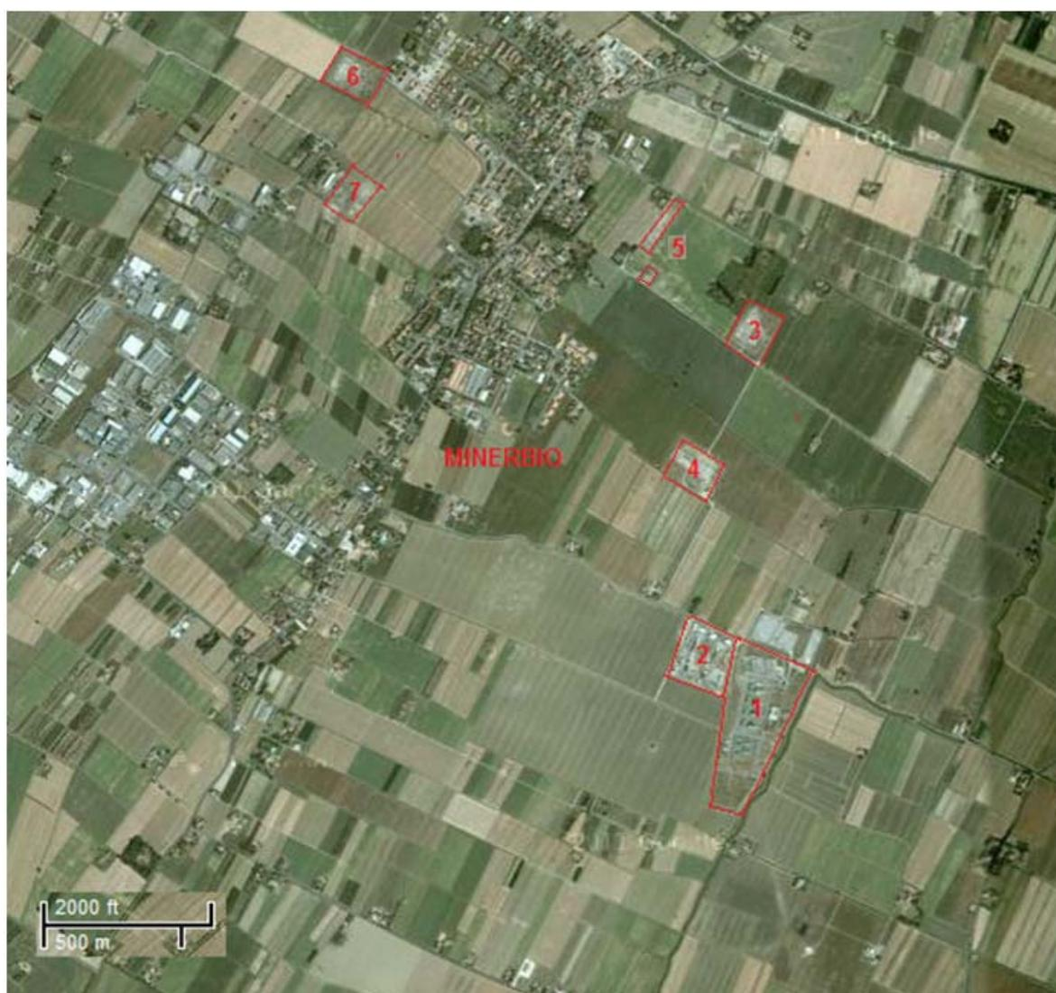
**Fig. 1.1.a – Principali infrastrutture della Concessione Minerbio Stoccaggio (base: immagine satellitare Google): (1) centrale compressione; (2) centrale trattamento; (3) cluster B; (4) cluster C; (5) cluster E-E1; (6) cluster A; (7) cluster D**
