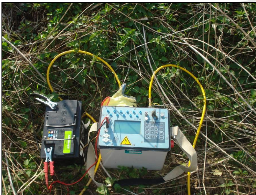
Foto n. 1 - Vista del georesistivimetro Iris instruments Syscal Pro
