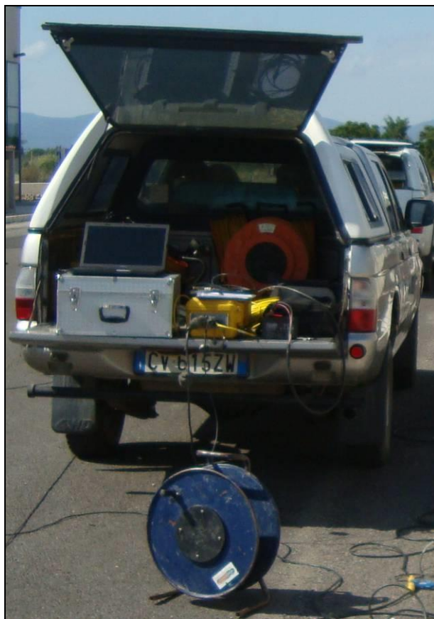
Foto 2 - Vista della strumentazione sismica utilizzata per l'esecuzione delle prove Masw
