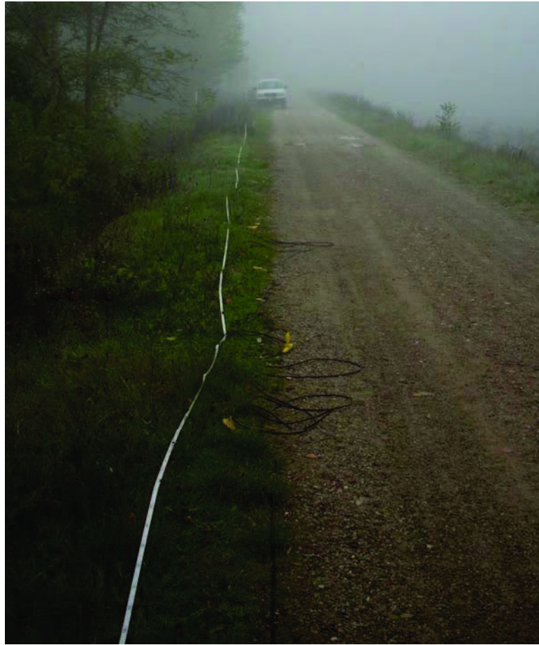
Figura 9 - Profilo sismico Re.Mi. HH' vista NW-SE
