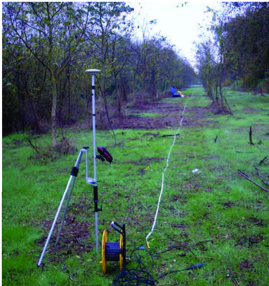
Figura 5 – Profilo sismico Re.Mi. DD', vista NW-SE
