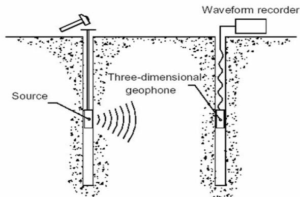
I sismogrammi acquisiti in campagna e registrati su *pen drive* sono stati successivamente esaminati per l'acquisizione dei tempi d'arrivo delle onde longitudinali (P) e trasversali (S). Noti i tempi di arrivo delle onde e le distanze tra i fori sono state calcolate le velocità di propagazione per ogni metro di profondità delle onde P ed S.
