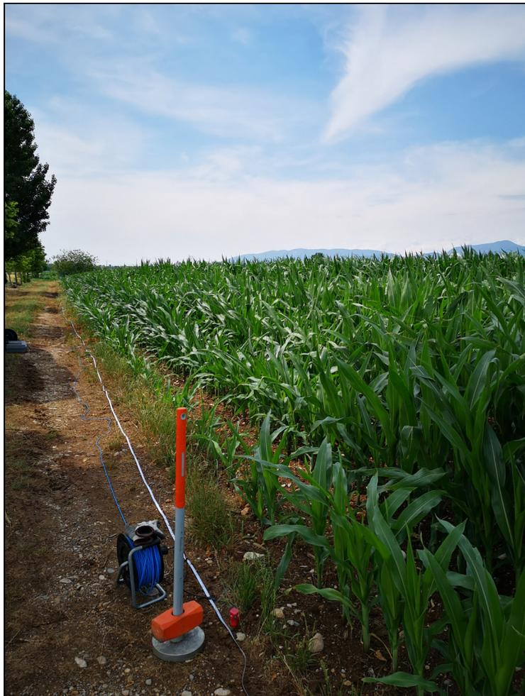
Foto 1: stendimento sismico effettuato.
