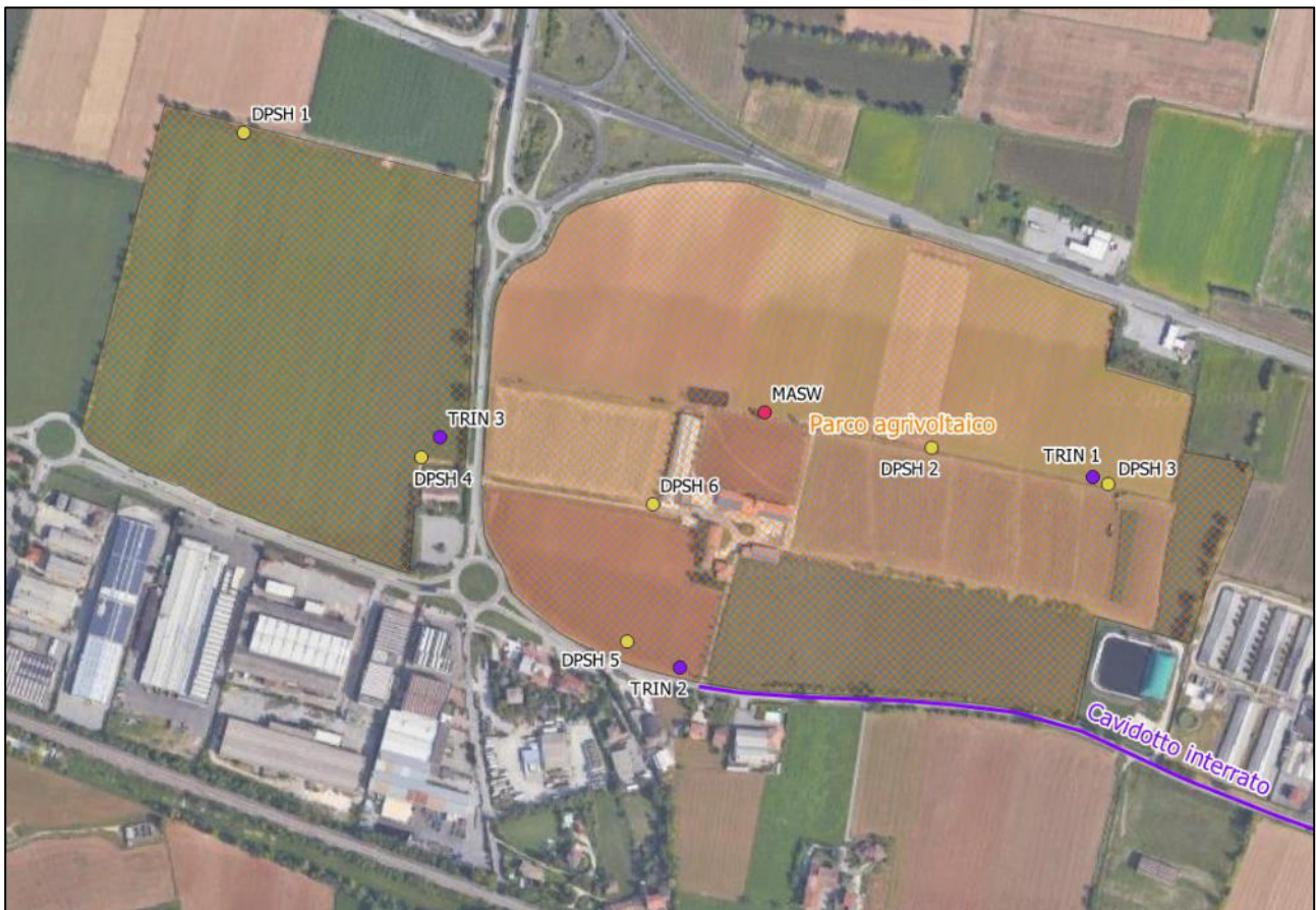
Figura 6.55: localizzazione dei punti d'indagine: MASW (cerchio rosso), DPSH (cerchio giallo), scavi esplorativi (cerchio viola).
