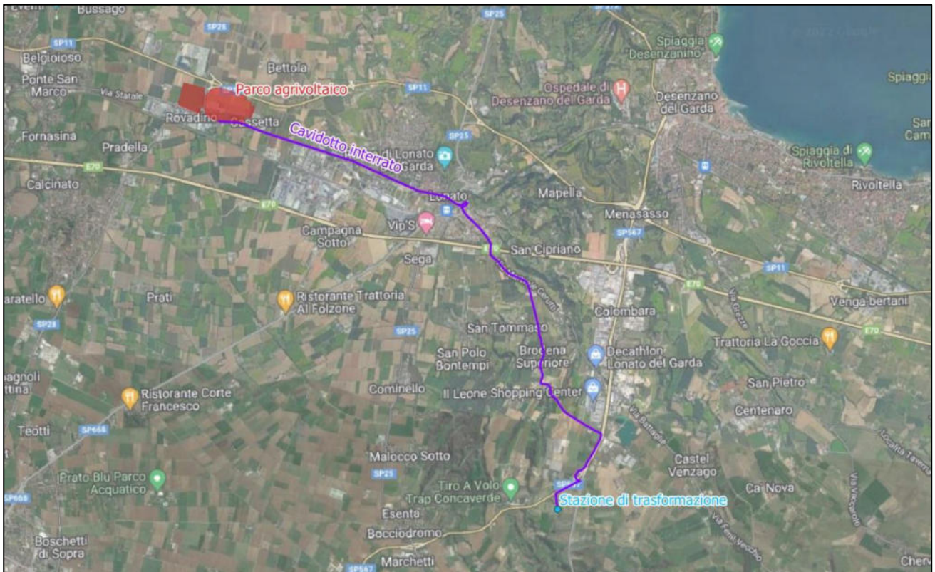
Figura 5.3: Planimetria dell'impianto di nuova realizzazione. Si notano il parco agrivoltaico, il cavo interrato e la sottostazione elettrica.
