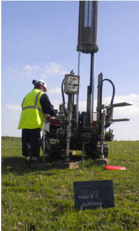
Prova penetrometrica dinamica DPSH 5
