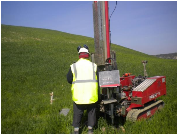
Prova penetrometrica dinamica DPSH 3
