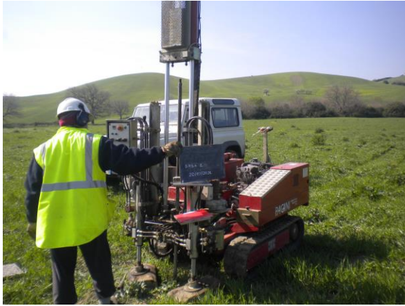
Prova penetrometrica dinamica DPSH 1
