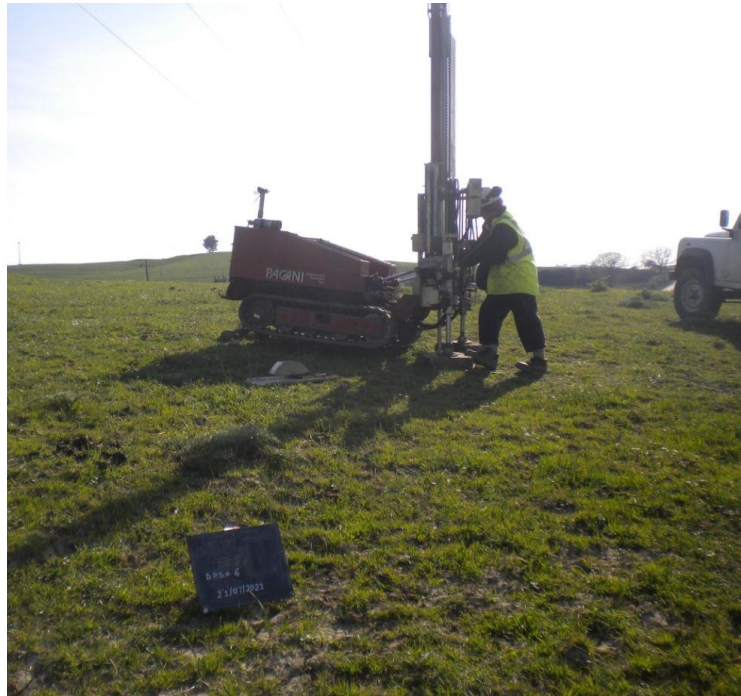
Prova penetrometrica dinamica DPSH 6
