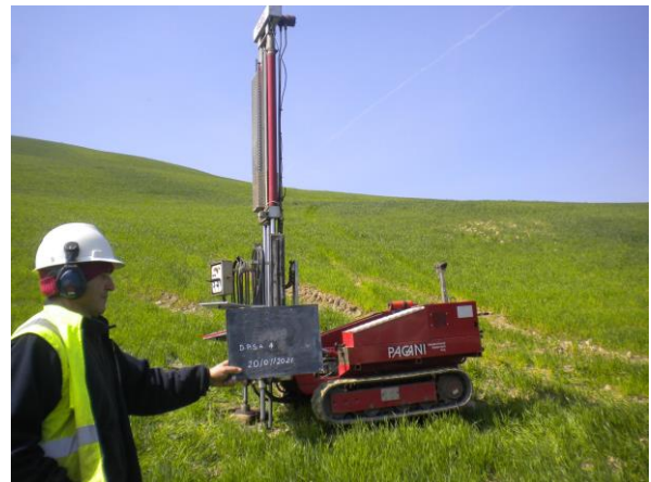
Prova penetrometrica dinamica DPSH 4
