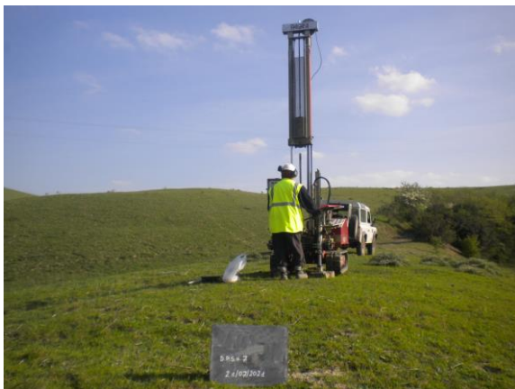
Prova penetrometrica dinamica DPSH 7
